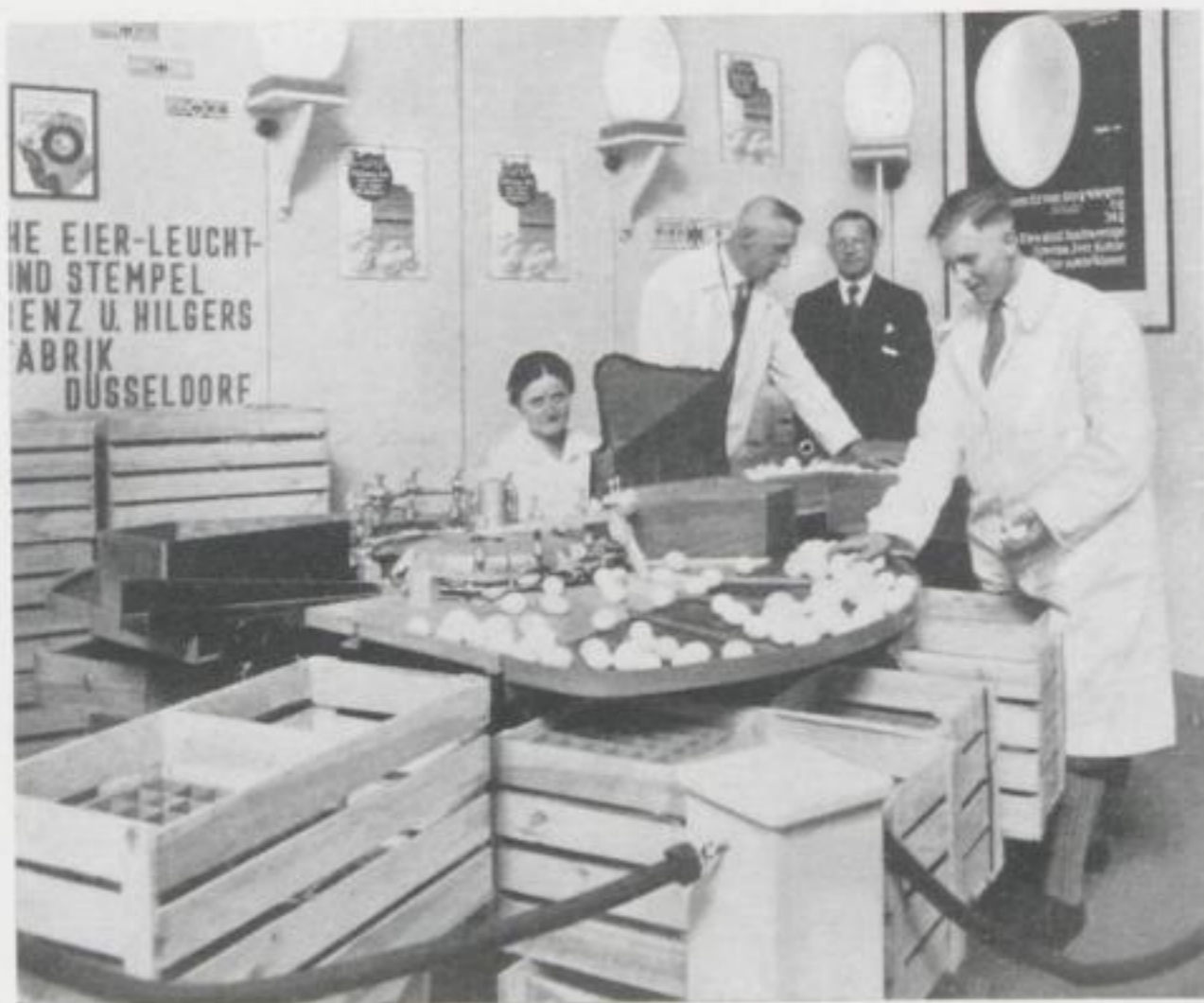
Abb. 36 Aus der Gruppe „Landwirtschaft“. Eine Eiersortiermaschine in Betrieb
