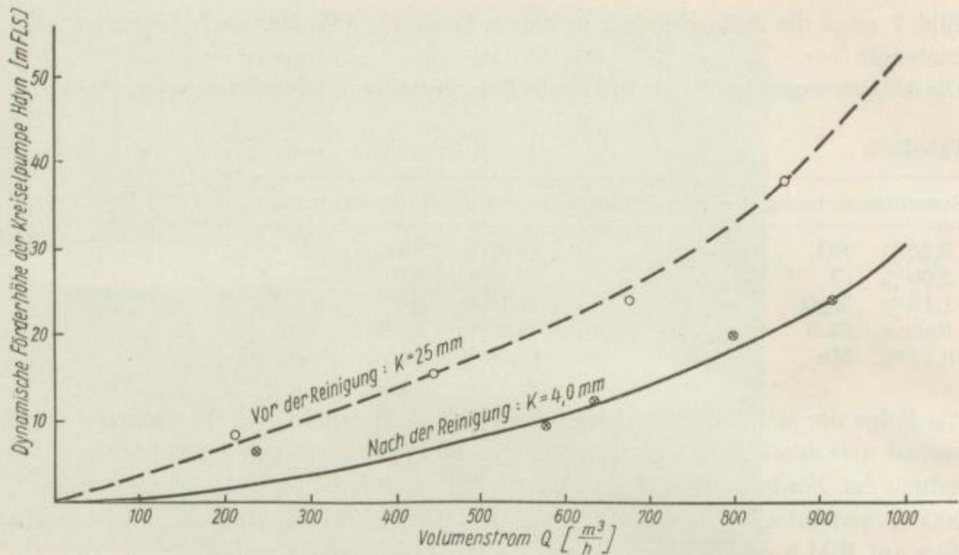
Bild 9. Kennlinien einer Gußrohrleitung NW 500 von 3000 m Länge
