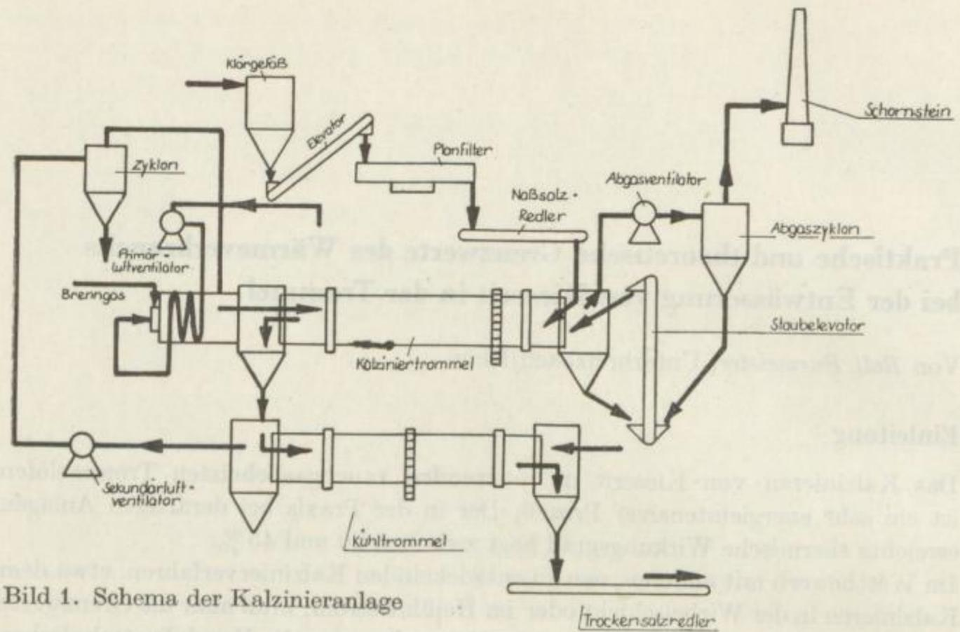
Bild 1. Schema der Kalzinieranlage
