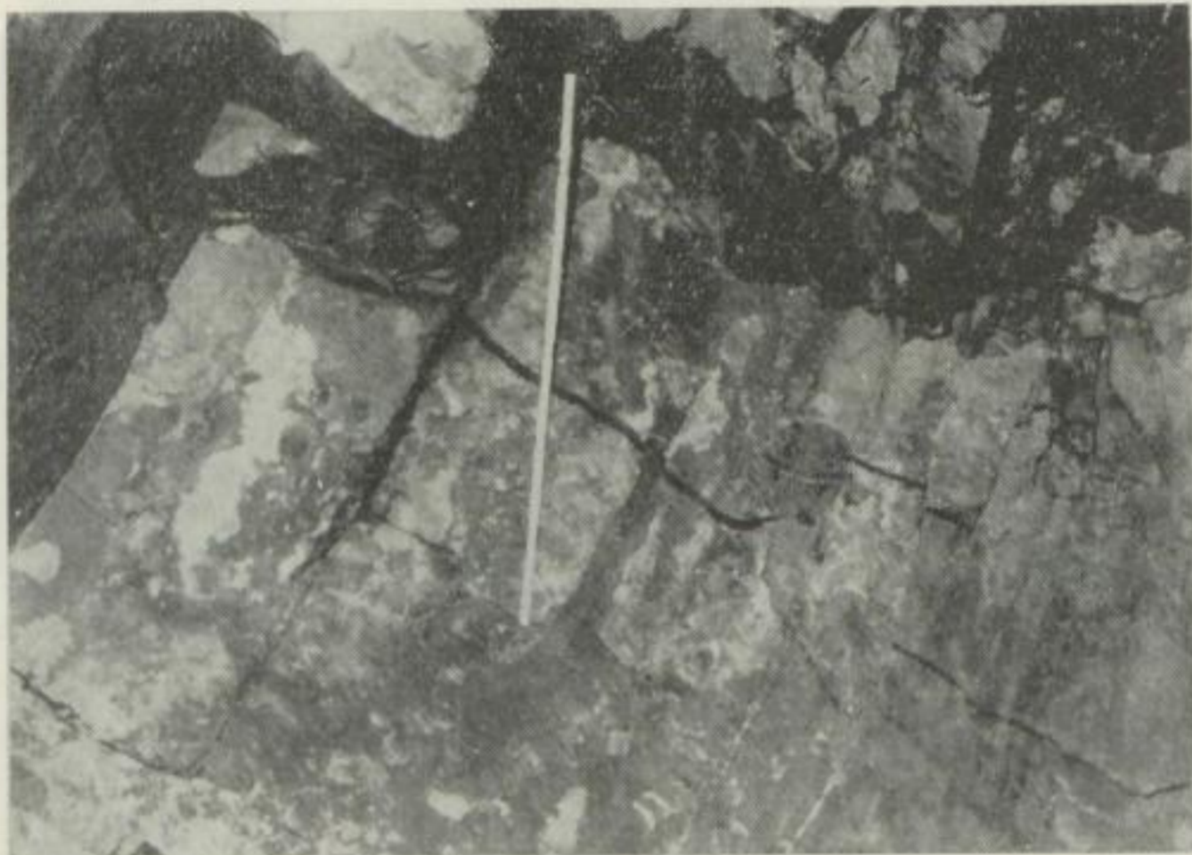
Abb. 23. Kammförmige Rißbildungen durch Schichtung (Kristalltuffbänke)
