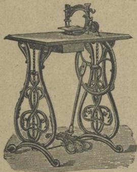
Die Naht bestand aus nur einem Faden (sogen. Kettelstich) und trennte sich die Naht von Anfang bis zu Ende von selbst auf, sobald sich eine einzige Schlinge löste.
