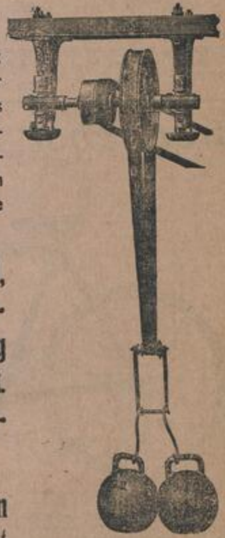
Vorrichtung zur Prüfung der Brennabor-Kugellager.
