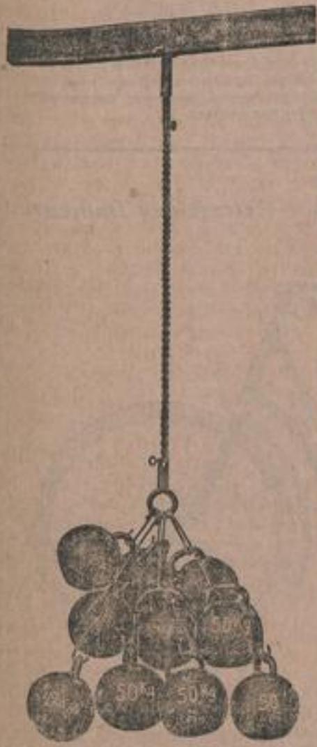
Belastungsprobe einer Brennabor-Kette.
