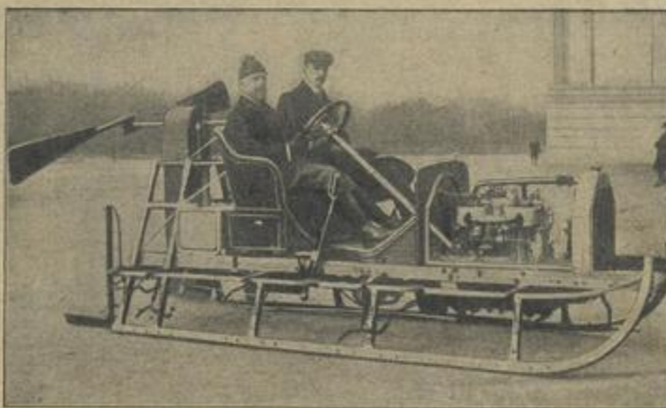
Ein neuer Motorfahrrad, dessen treibende Kraft ein durch den Motor angetriebener Propeller ist. Der Propeller ist hinter dem Schlittensitz angebracht. Die Steuerung erfolgt durch zwei Steuererüber, die hinter den Rufen drehbar gelagert sind. Sie ist somit ähnlich der Steuerung eines Bootes. Bei Probeversuchen wurde im weichen Schnee eine Geschwindigkeit von 40 Kilometern, auf hartgefrorenem Schnee etwa das Doppelte in der Stunde erzielt.
