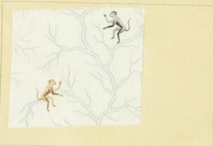
Die mit obigen Farben bedruckten Stoffe, (siehe Muster) werden nach dem Drucke zur Entwicklung des Anilinschwarzes in die Oxydirbaude (Rösche) gebracht, ein Local, wo die Temperatur auf 20 — 24° R. gebracht ist. Je nach der Schwere des Musters, bleiben dieselben 2 — 3 Tage daselbst, bis das Schwarz intensiv erscheint; man dämpft nun, und erhalten die Stücke folgenden Durchzug im Rollenständer:
