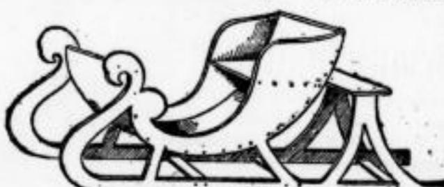
Kästenholz mit der Laubsäge ausgeschnitten. Seitenteile sowie Sitz werden zweimal geschnitten. Der Boden des Schlittens wird quer genommen. Nachdem er ausgeschnitten, wird er nach gemacht, über Sitz langsam rund gebogen und den Seitenteilen eingeschnitten. Ist der Schlitten fertig, streicht man ihn beliebig an.
