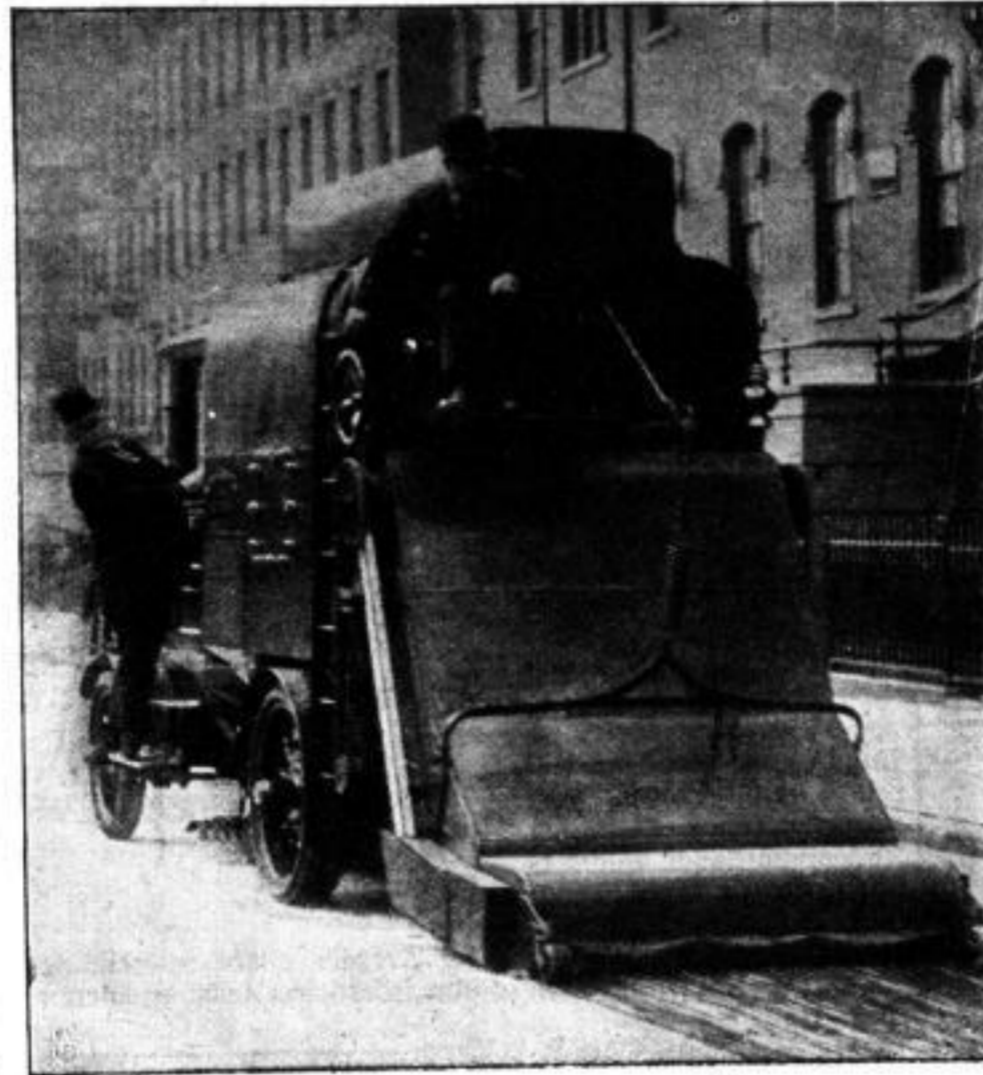
Neue Straßenreinigungsmaschine mit Automobilbetrieb. (Mit Text.)
