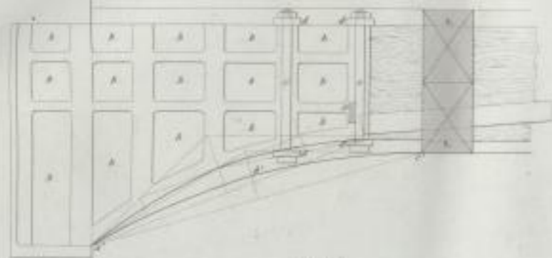
Fig. 2. Plan des deux linteaux composant l'armature en fonte servant à l'encastrement des poutres.
