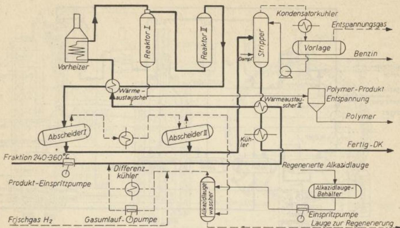
Bild 9. Technologisches Prinzipschema der DK-Raffination
