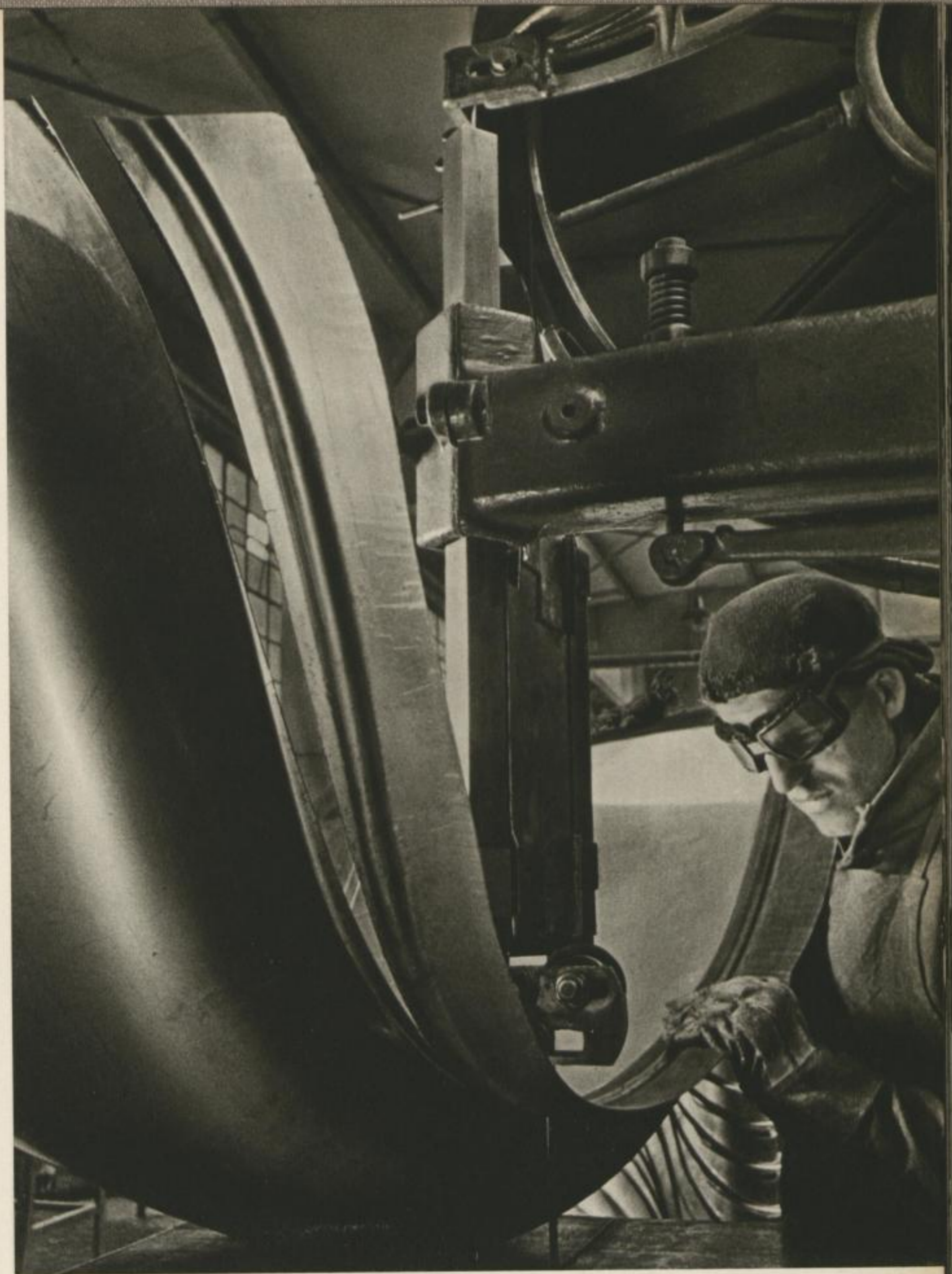
Der Rand, an dem die Ziehpresse die Blechteile festhielt, um die tiefe Mulde des Kotflügels draus zu „ziehen“, wird mit der Bandsäge entfernt. Blech-Bandsäge · Sheet-metal Band-saw · Scie à ruban pour tôle
