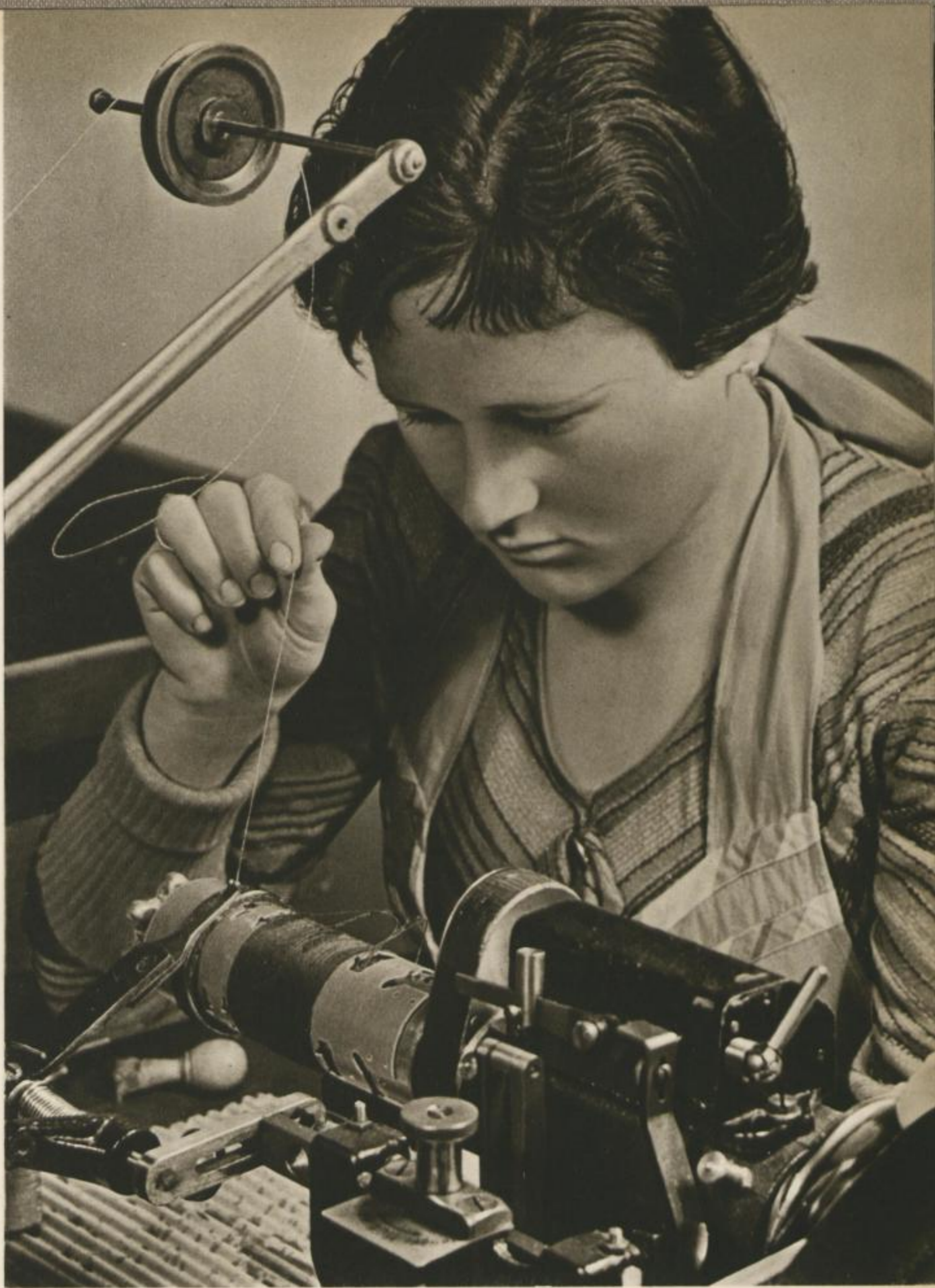
Spulenwicklerinnen einer Radiofabrik im Schwarzwald · Spool-winders in a Black Forest Wireless Factory · Ouvrières pour ligature de bobines d'une fabrique de radios dans la Forêt-Noire
