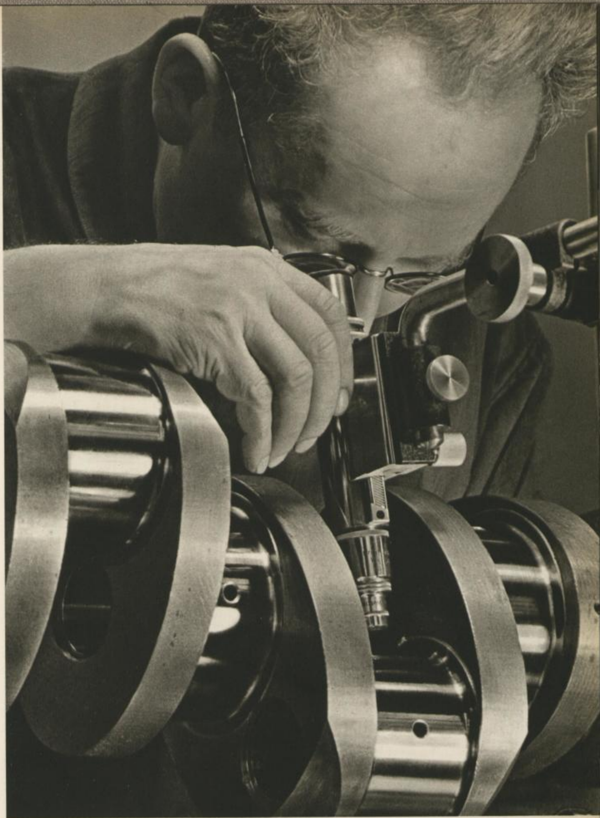
Der Herzmuskel des Kraftwagenmotors: Nicht der kleinste Fehler darf der Prüfung dieses höchst belasteten Werkstückes entgehen, spiegelblank müssen die Lagerstellen sein. Kurbelwellen · Crankshafts · Arbrennmanivelle
