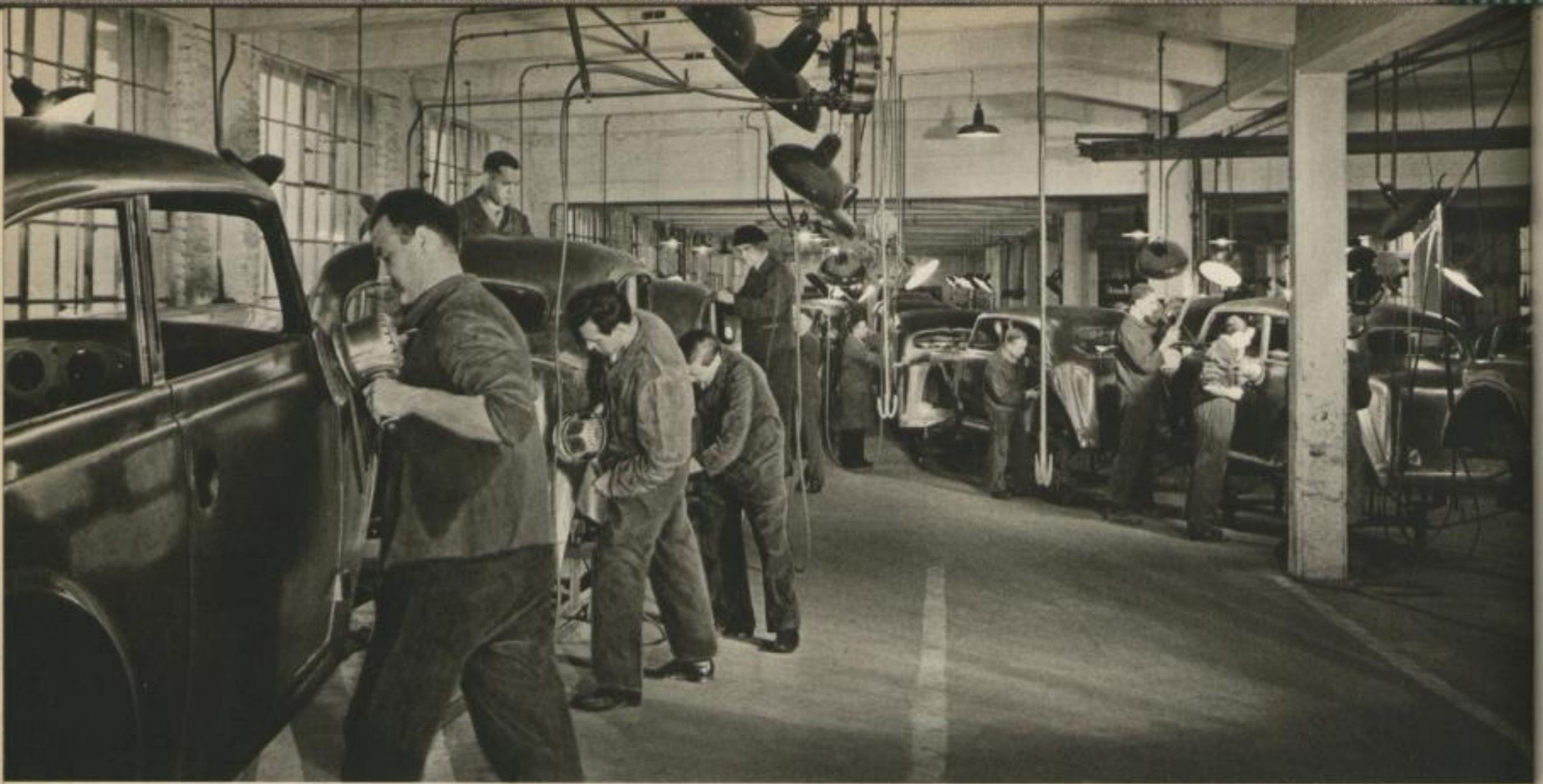
— — — geglättet und poliert, denn die nachfolgende Lackierung würde jeden kleinsten Fehler sichtbar machen. Glazing and Polishing the Body · Lissage et polissage de la carrosserie
