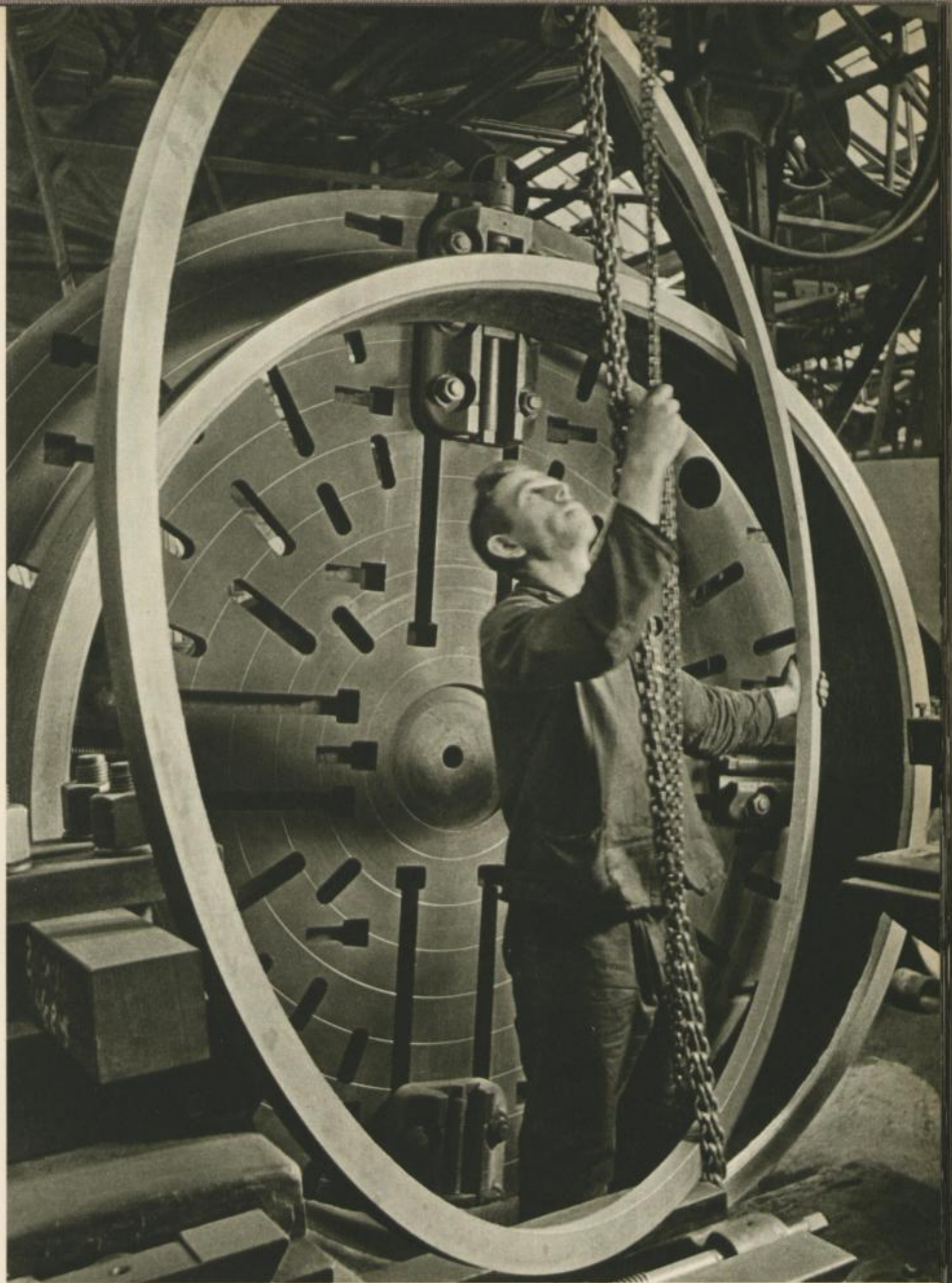
Wer denkt bei „Kolbenring“ nicht an die armbandgroßen Reifen des Automotors? Der Unterschied zwischen Groß und Klein wird in der Technik unserer Zeit immer bedeutungsloser. Piston Ring, 3 metres in Diameter • Segment de piston de 3 mètres de diamètre
