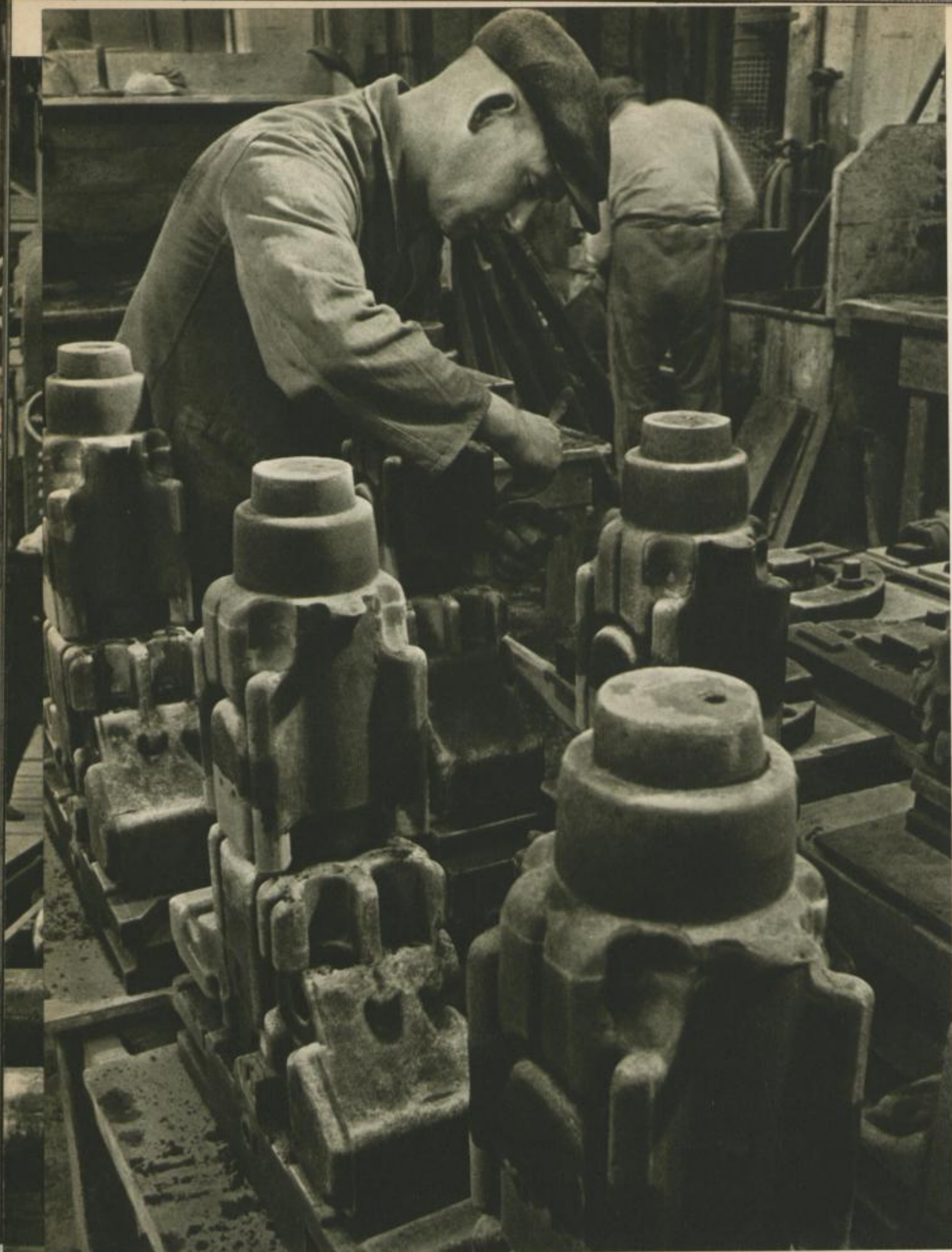
Gußkerne werden fertig gemacht zum Einbau in die Form. Former sind „Bildhauer“ in Sand und Lehm! Kernformerei · Core Moulding · Modèles pour fonte
