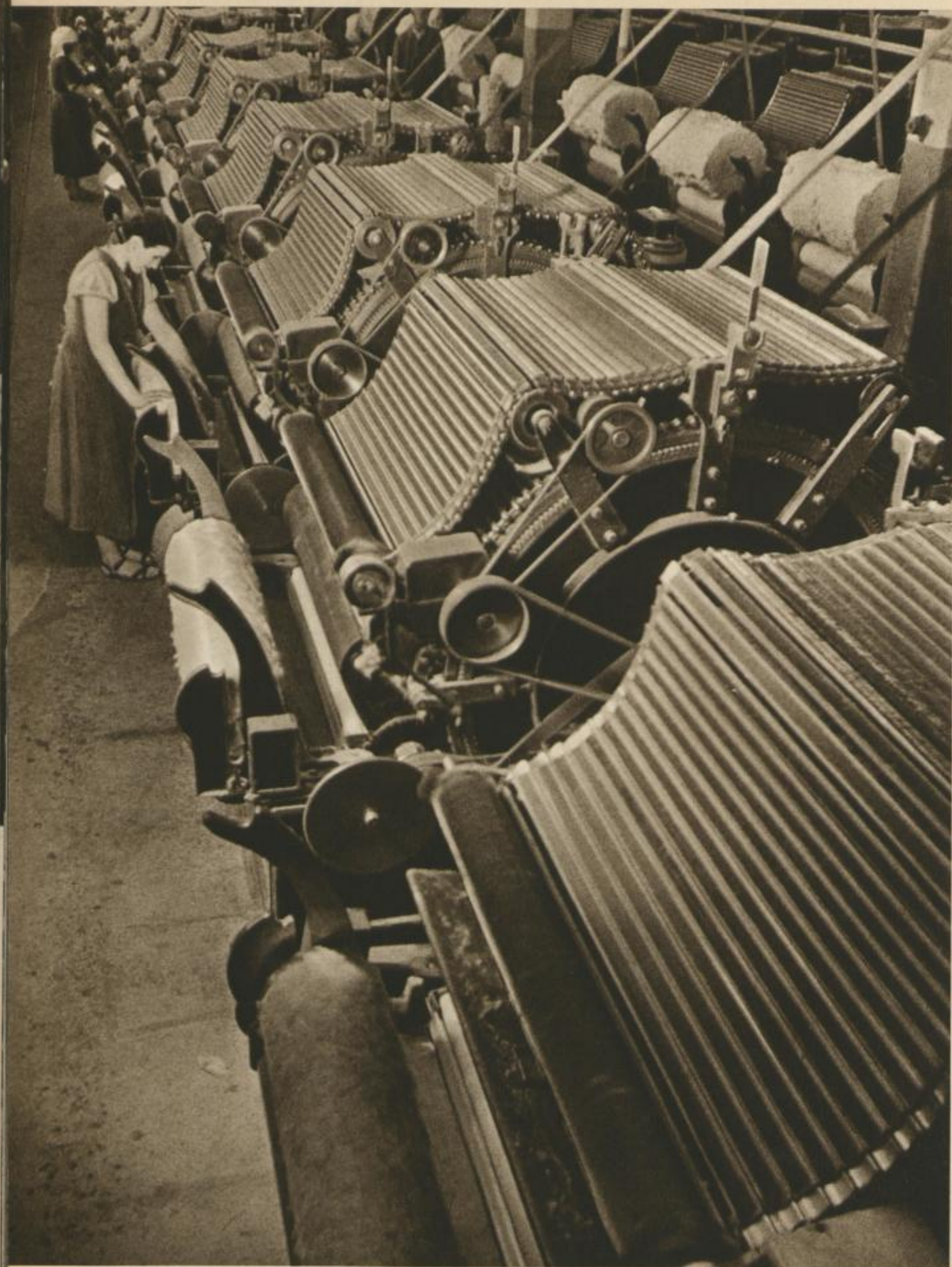
Walzen und Trommeln, bewaffnet mit aber Tausenden feiner Zähne und Hähchen, verwandeln die Faserflocken in ein hauchdünnes „Vlies“, das ... „Karderie“ einer bayrischen Spinnerei · Carding Machines in a Bavarian Spinning Mill · Carderie dans une filature bavaroise: atelier où l'on carde
