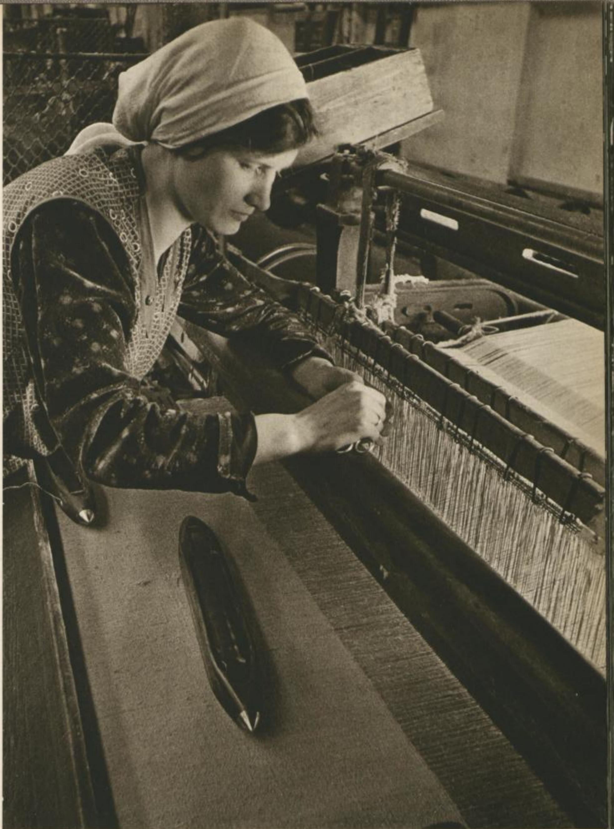
... Webstuhl. Hier wird die „Kette“ mit dem im „Schiffchen“ aufgespulten „Schuß“ durchschossen und zum fertigen Tuch verwebt. Webstuhl · Weaving-loom · Métier à tisser
