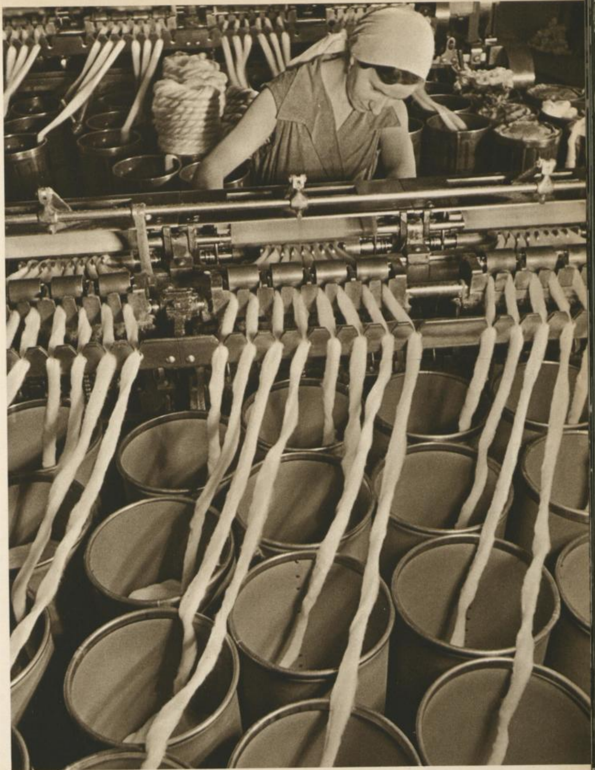
..... zu einer „Lunte“ zusammengefaßt in „Kannen“ spiralg abgelegt wird. Aus acht Lunten wird hier ein „Strang“ „gedoppelt“. Spinnmaschine · Spinning Machine · Machine à filer
