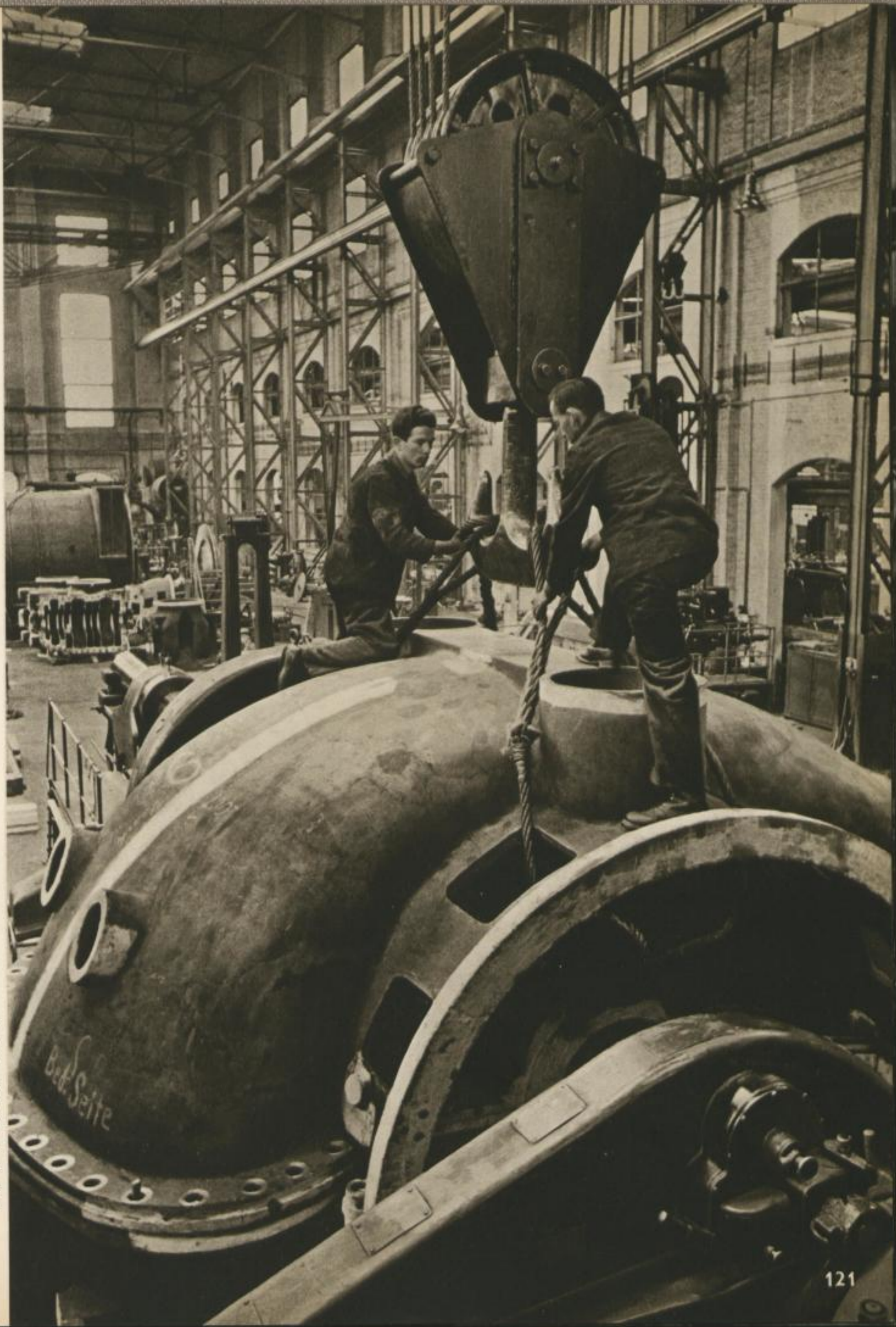
Ljungström - Turbine einer bayrischen Maschinenfabrik. Ljungström Turbine in a Bavarian Machine Factory Turbine de Ljung- ström d'une fabrique de machines bavaroise
