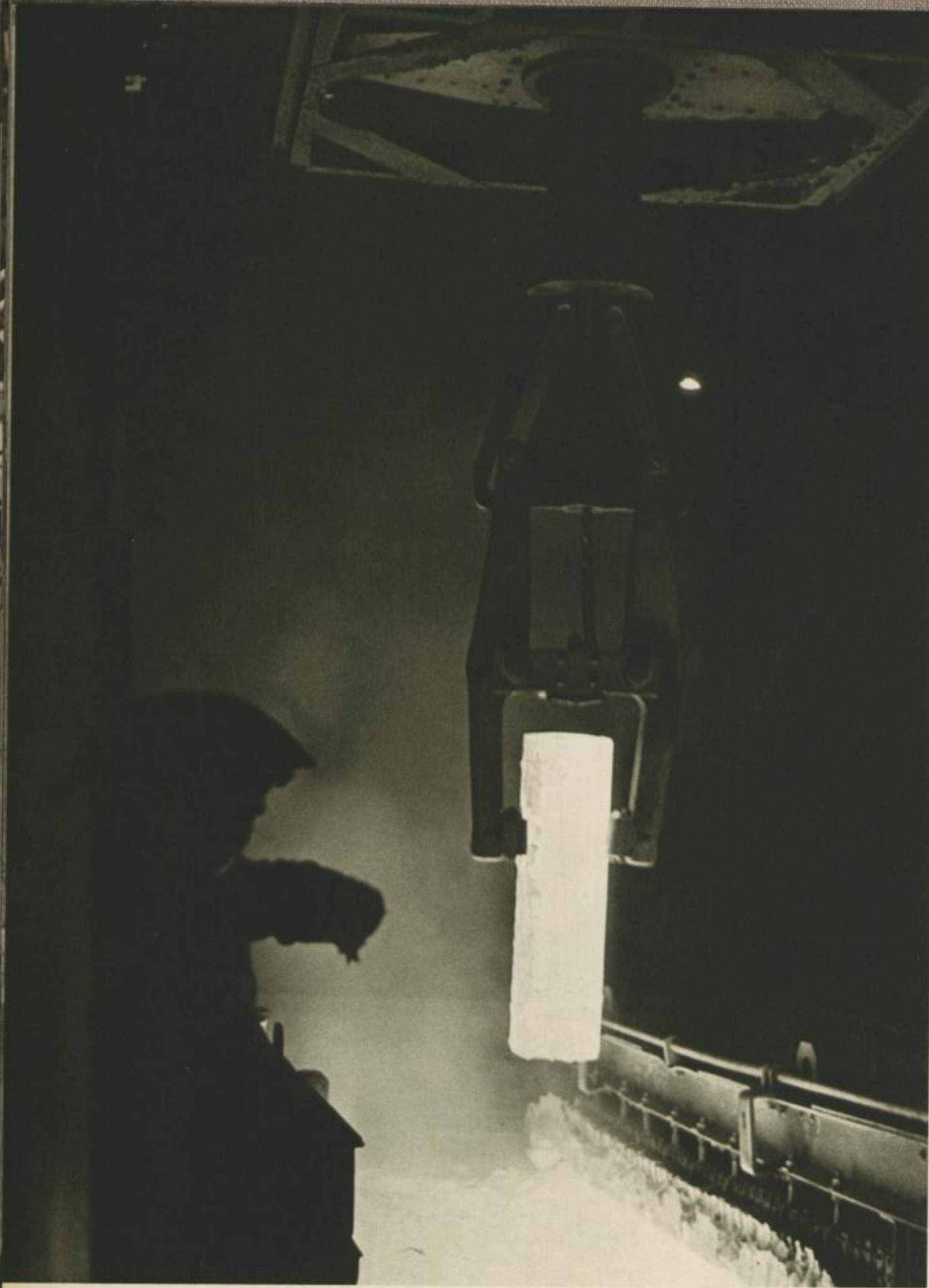
In blendender Weißglut strahlt der Stahlblock, der aus dem Glühofen gehoben wird, um in Walzwerk oder Schmiedepresse geformt zu werden. Glühofen · Annealing Furnace · Four à recuire
