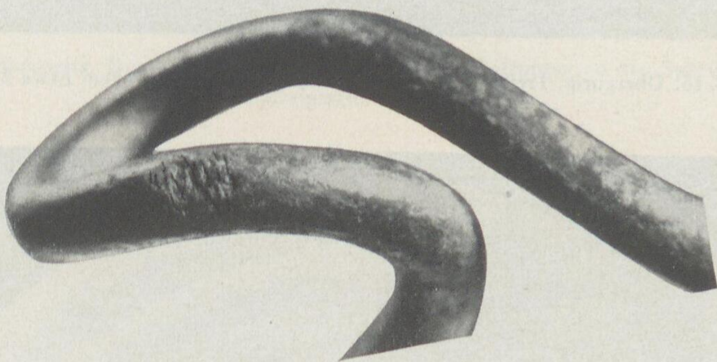
Abb. 15. Obergurig. Feuerrißbildung an der Nadelrast. Etwa 2:1.
