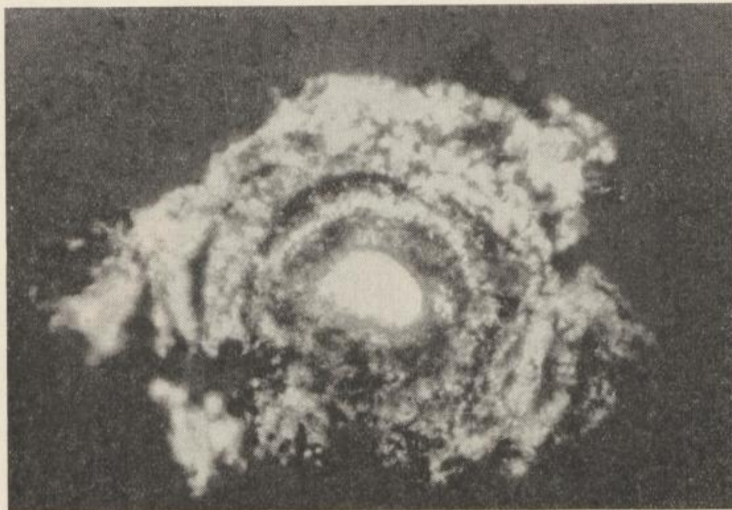
Bild 3. Quarzkorn (Bildmitte) mit Reaktionssaum und Kalziumkarbonatumkrustungen aus einer unverfestigten Druckgasgeneratorasche (Vergrößerung 230 : 1)
