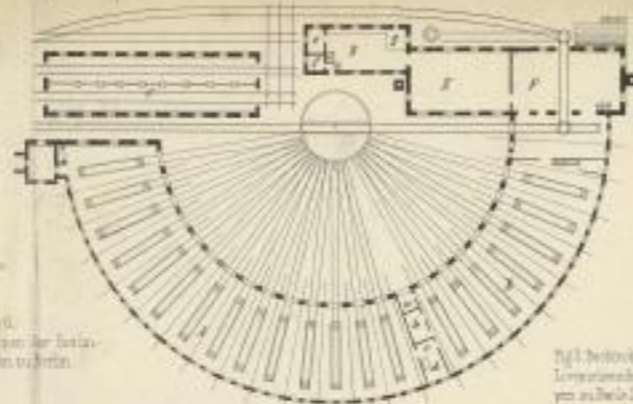
Grundriss des zentralen Einbaubaus
