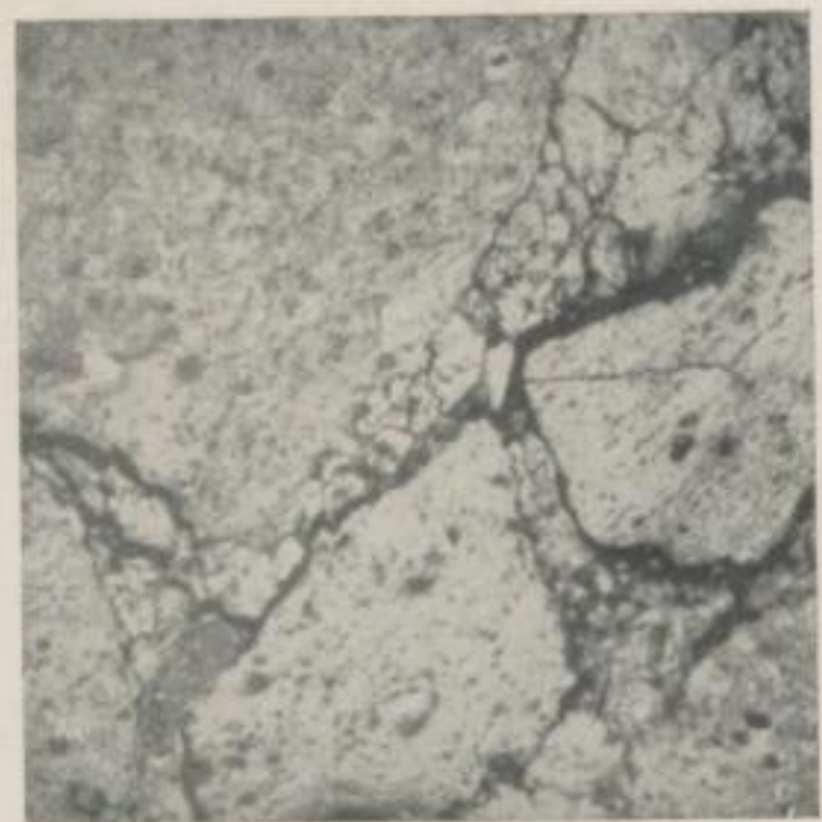
Bild 13. Unterschiedliche Breite der Korngrenzrisse bei Grob- und Feinkorn — Bitterfeld — Hellfeld; V = 80
