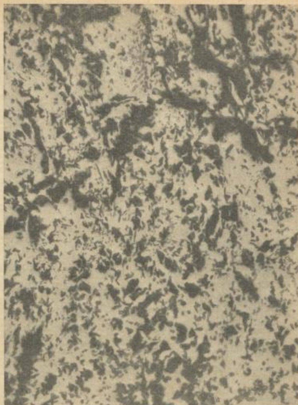
Bild 12. Schliffbild von Braunkohlenkoks
