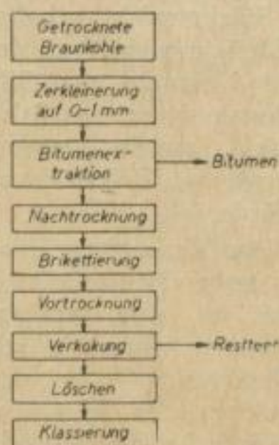
Bild 9. Mögliches Verfahren der Braunkohlen-HT-Koks-Herstellung unter Einschaltung eines Verfahrens zur Bitumenextraktion vor der Schwelung nach Krafft zwecks Stückschwelkoks-gewinnung
