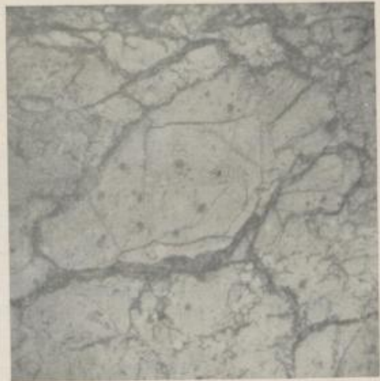
Bild 11. Dopplerit mit Eigen- und Korngrenzrisßbildung — Nachterstedt — Hellfeld; V = 80
