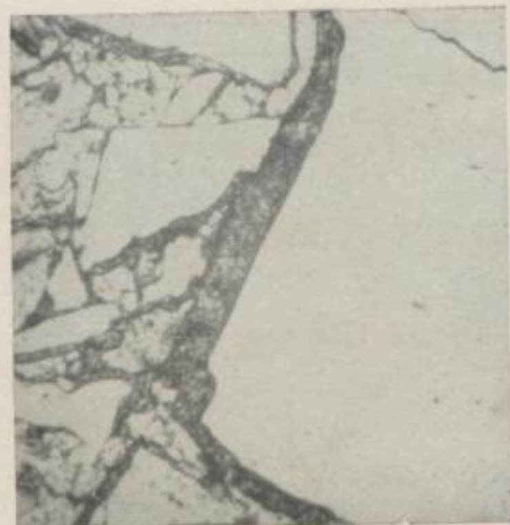
Bild 12. Dopplerit mit sehr schlechtem Verband — Olbersdorf — Hellfeld; V = 80
