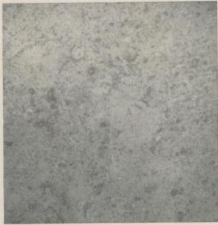
Bild 8. Bitumenkohle mit rissfreiem Brikettverband — Nachterstedt — Hellfeld; V = 80
