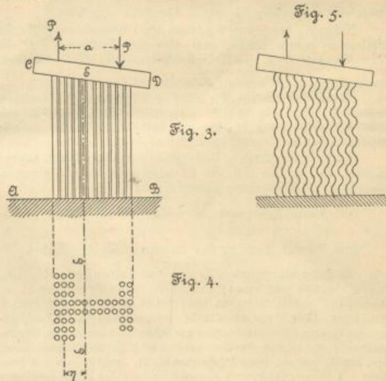
Wie ohne weiteres ersichtlich, sind bei dieser Sachlage die Dehnungen der Fasern proportional dem Abstände von der Achse, so dass also, wenn die Dehnung, d. h. die auf die Einheit der ursprünglichen Länge bezogene Verlängerung im Abstände 1 von der Achse  $\epsilon'$  beträgt, die um  $\eta$  davon abgelegenen Fasern eine Dehnung
