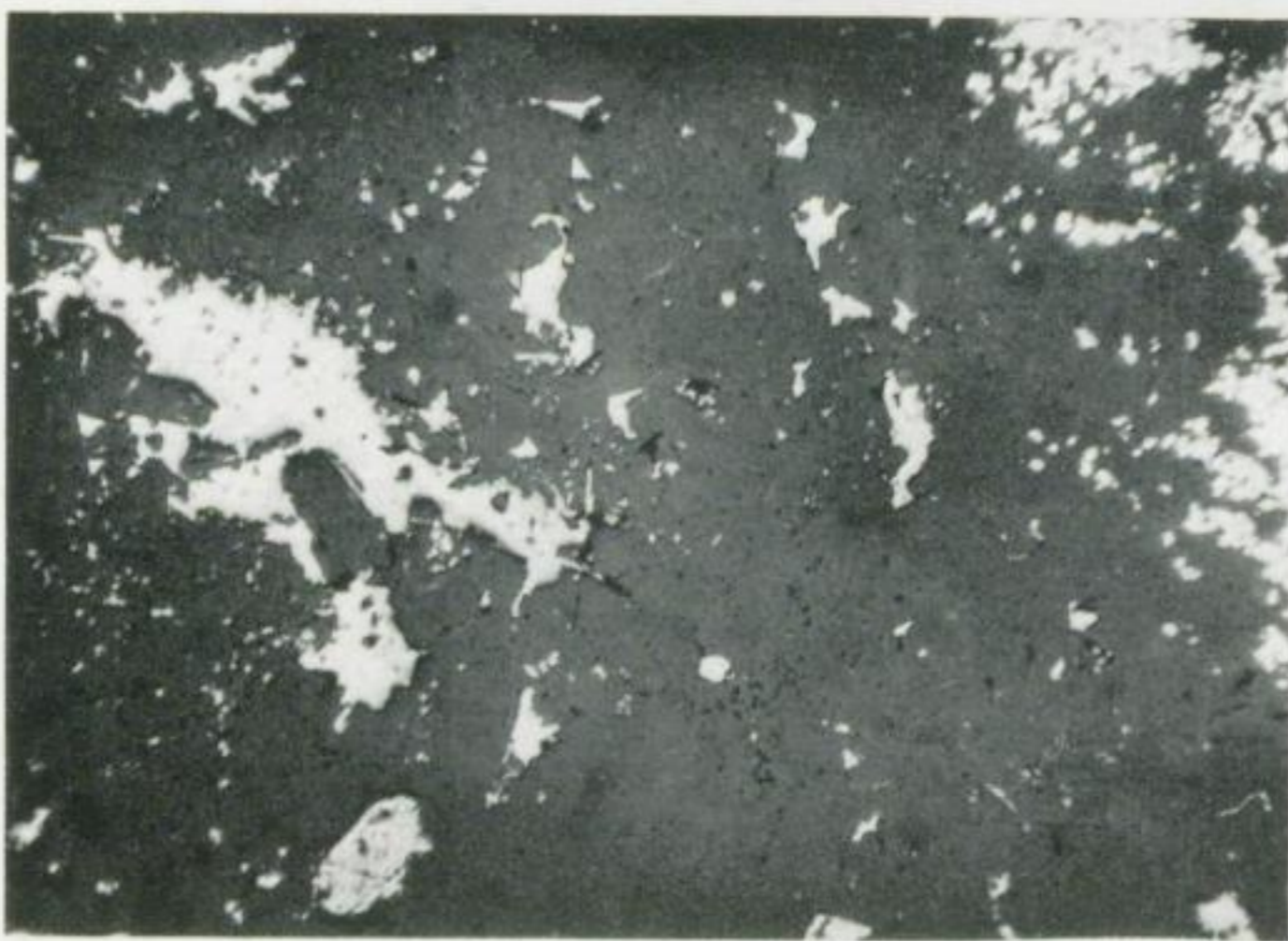
Bild 72. (Schliff Nr. 80) Gangbezirk Reinsberg („Schönberg Erbst.“), Christi Hilfe Mg., St.-S. Boulangierit in nadeligen Aggregaten (reinweiß) im Quarz I. Randlich „Tressenerz“-Bildungen. Vergr. 48 : 1
