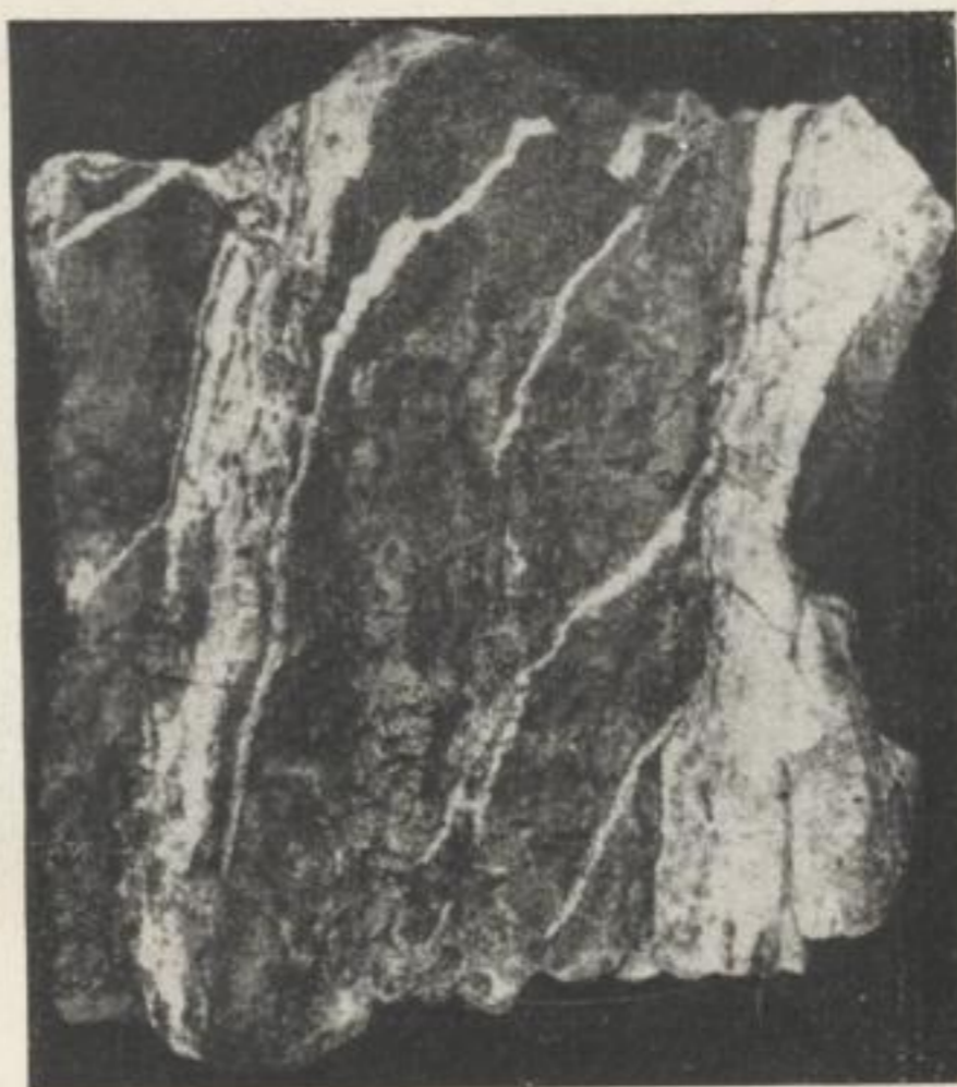
Bild 53 M. 1 : 3 Revier Brand (Himmelsfürst), Schweinskopf Fl., 15. Gez.-Str. Jüngere Fiederspältchen, mit Karbonspäten der eb -Formation gefüllt, innerhalb der älteren Gangspalte (mit vorwiegend kb -Paragenesen)
