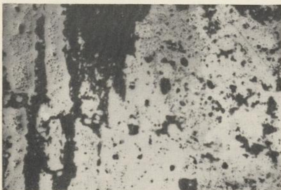
Bild 70 Vergr. 28 : 1 Revier Brand, Neue hohe Birke Sth., 8. Gez.-Str. Kupferkies I (weiß) geht über in Tetraedrit I (hellgrau). Die- ser wird orientiert von Kar- bonspat (schwarz) verdrängt
