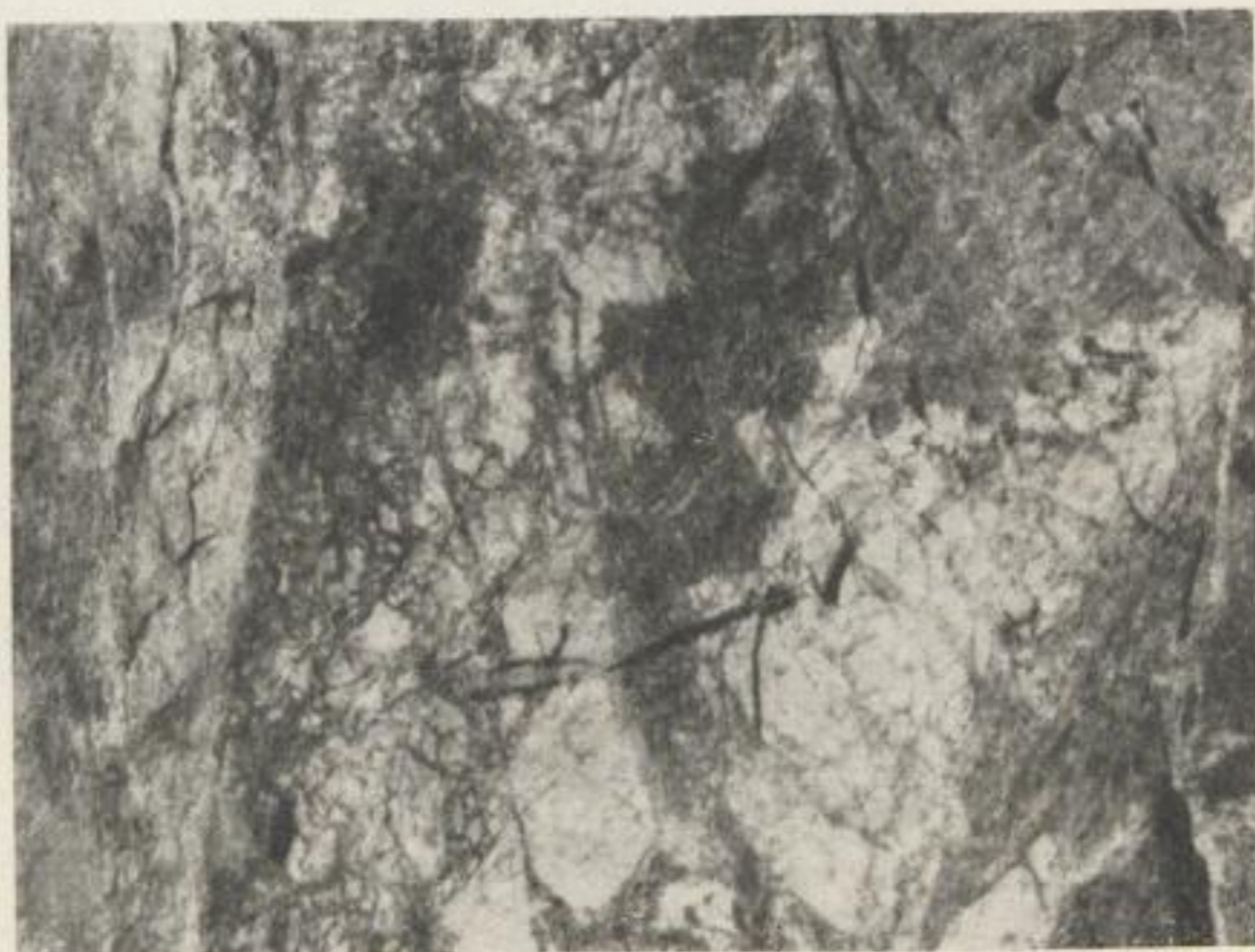
Bild 103 M. 1 : 17 Revier Freiberg, Hauptstolln- gang Sth., 8. Gez.-Str. kb -Formation: Gangfüllung analog der „Breccie“ vom Re- vier Halsbrücke
