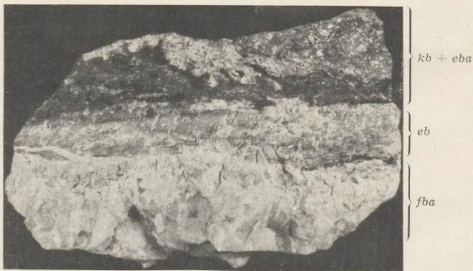
Bild 104 M. 1 : 2 Revier Halsbrücke, Samuel Sp., 7. Gez.-Str. Lagenförmige Entwicklung von kb -, eb - und fa -Paragenesen
