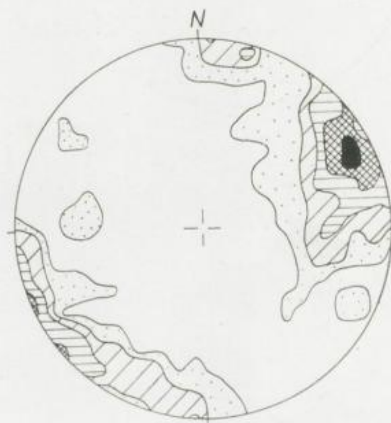
Bild 20. 163 Klüfte, gemessen an einer Klippe am Osthang des Wippertales, nördlich der Klippmühle.
