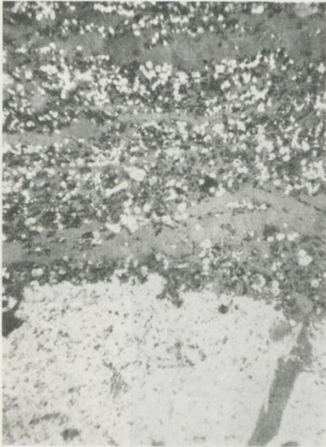
Bild 9 (Anschliff) Vergr. 50 : 1, 1 Nic. Grube Halsbrücke, „Felsithorizont“ (Lager II), 8. Gez. Str. Feinkörnige, kristalloblastische Magnetitkonkretionen (weiß), lagenförmig angeordnet (Schichtgefüge), verdichten sich zu größeren, kompakten Aggregaten. Silikatische und karbonatische Grundmasse (dunkelgrau)
