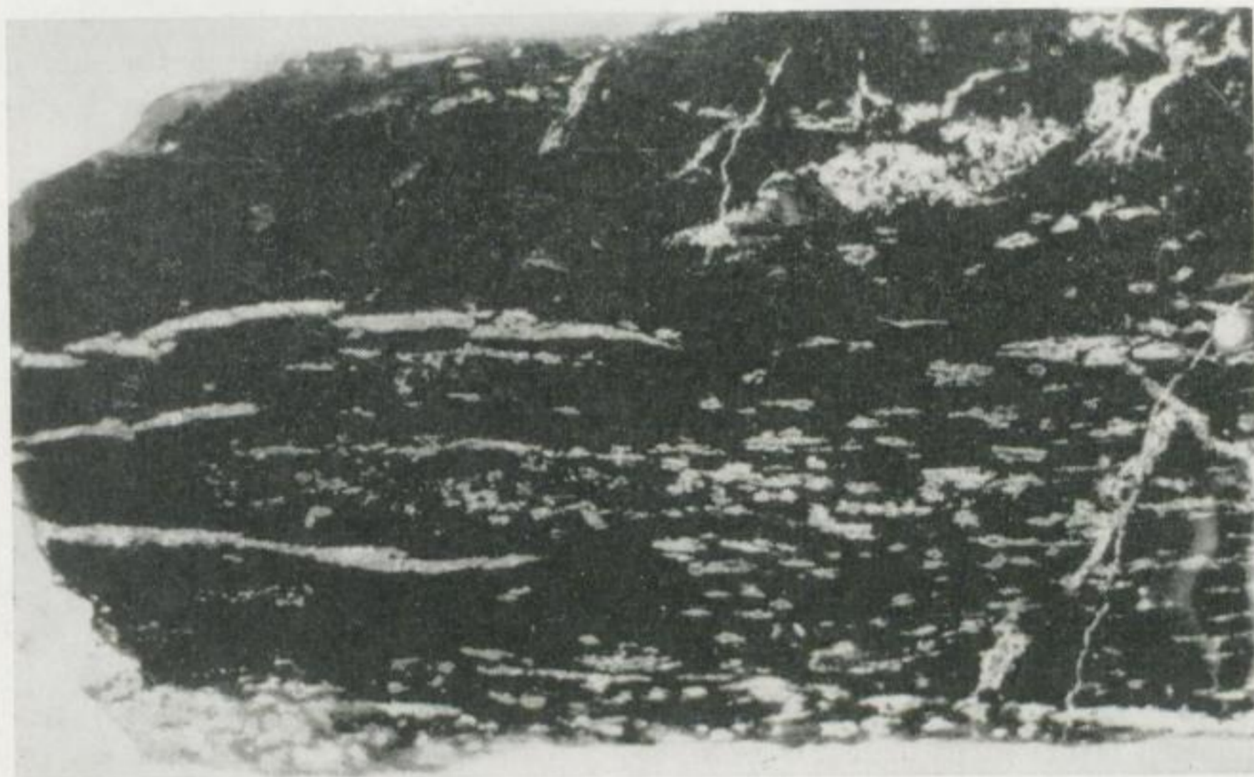
Bild 4. (Großanschliff) Vergr. 2 : 1 Grube Halsbrücke, „Felsithorizont“ (Lager I), 6. Gez. Str. Parallelgeschichtete Einlagerungen von Pyrit und Markasit im Schwarzschiefer (aus Griebmann, 1963)
