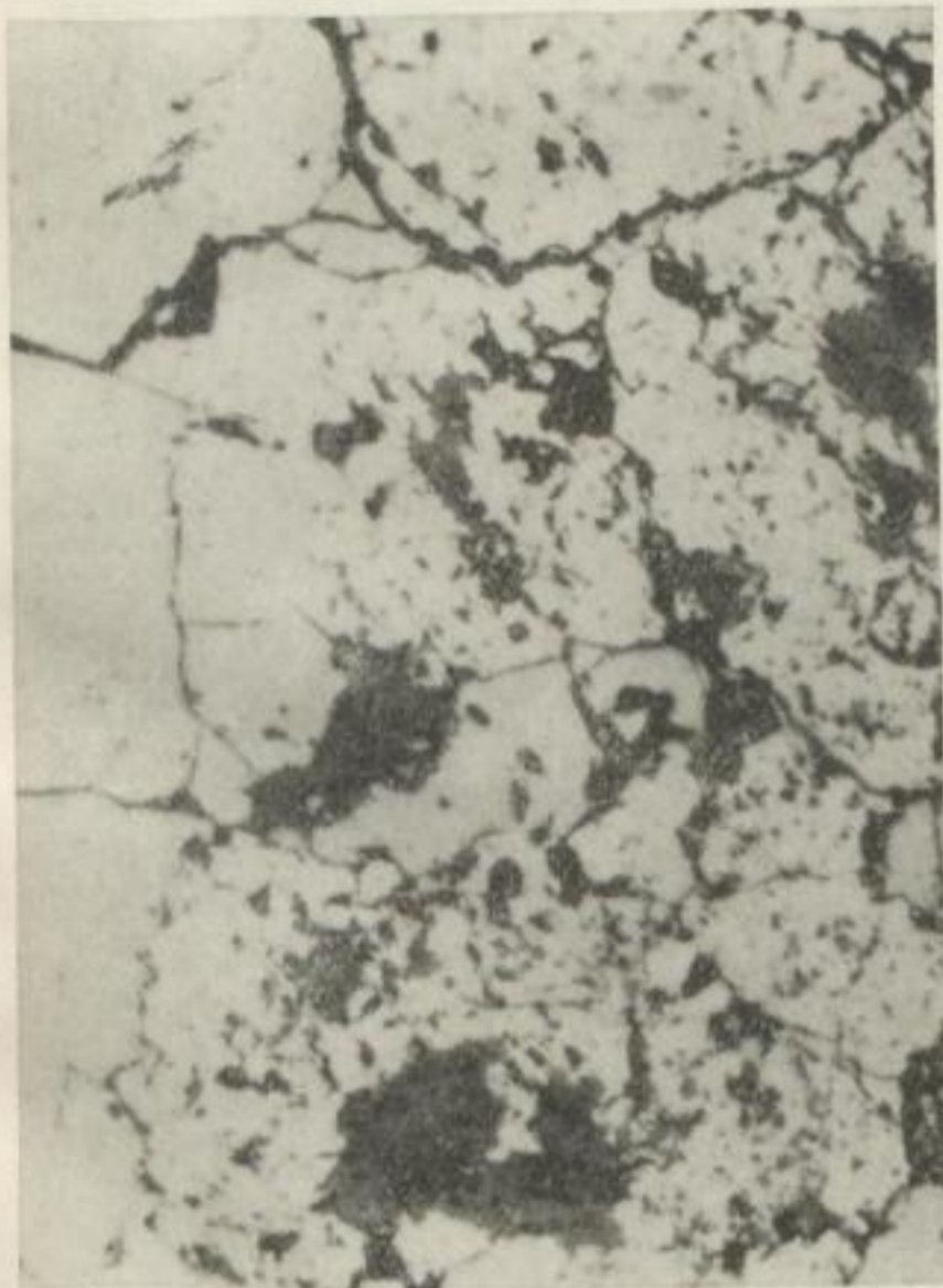
Bild 1. Derbe Zinkblende neben stark zerklüfteten und fein mit Gangart verwachsenem Magnetit. Vergrößerung: 50:1
