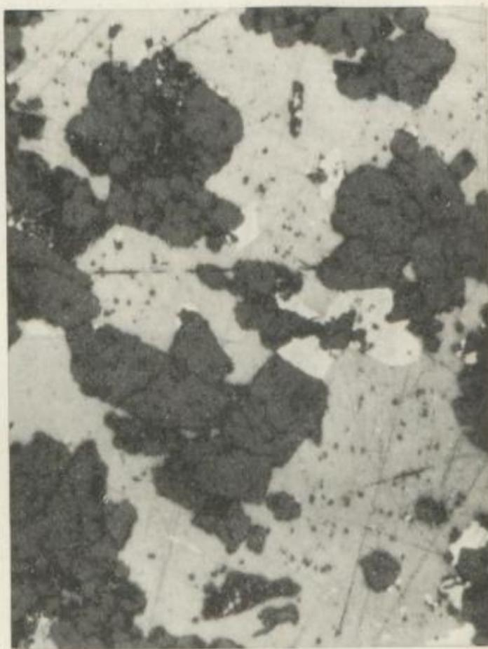
Bild 4. Zinkblende mit Kupferkiesentmischungen in Gangart. Vergrößerung: 50:1
