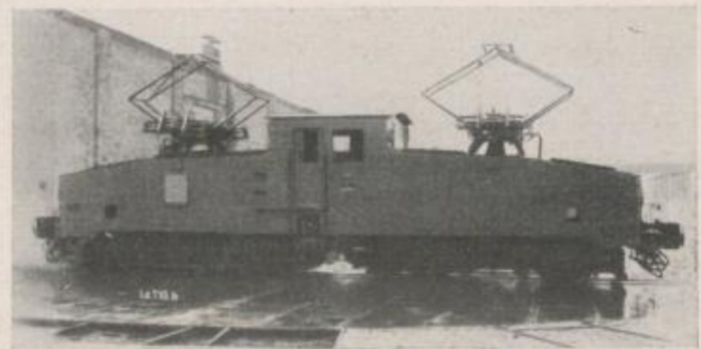
Bild 5. Elektrische Tagebaulokomotive El 2 (SSW) Spurweite 1435 mm; Dienstgewicht 80—100 t; Stundenzugkraft 13—17 t; Bauzeit seit 1934
