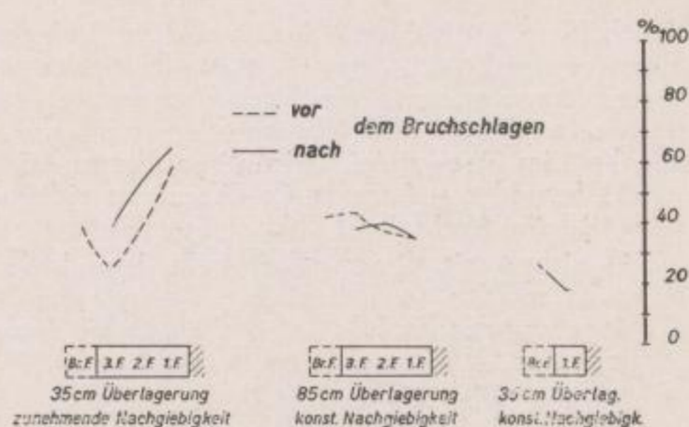
Bild 20. Belastung des Strebraumes (in % vom Überlagerungsdruck)
