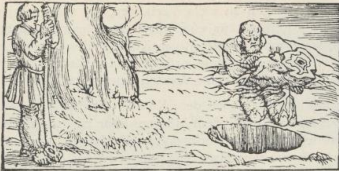
Bild 46. Verkohlung von Stockholz in Gruben um 1540 (Nach dem Holzschnitt in der ‚Pirotechnia‘ des VANOCIO BIRINGUCCIO aus Siena)
