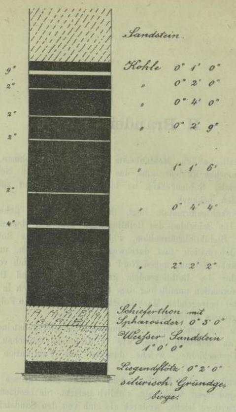
dem Kübeck-Schachte erschlossenen grössten Mächtigkeit. Dieses Kohlenflötz, welches von Ost nach West streicht, und im Nord durchschnittlich mit 6—10 Grad einfällt, ist von mehreren unbedeutenden, feinkörnigen, stark eisen- und thonhältigen, meist pflanzenführenden Sandsteineinlagerungen, in mehrere Bänke getheilt. Dieselben alteriren jedoch ihrer geringen Stärke wegen, die Einheit des Flötzes durchaus nicht, und kann dasselbe füglich als ein Ganzes betrachtet werden.
