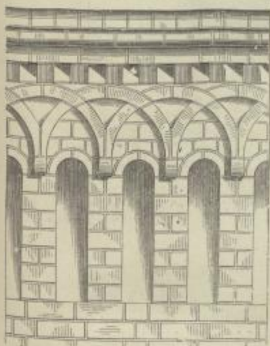
2. Hauptgesims aus Ziegelstein an der Apsis zu Dobrilugk.
