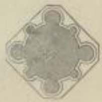
8. Durchschnitt eines gotischen Pfeilers. 4 stark gebildete alte Dienste für die Längs- u. Quergurte u. 4 schwächere junge Dienste für die Kreuzrippen.
