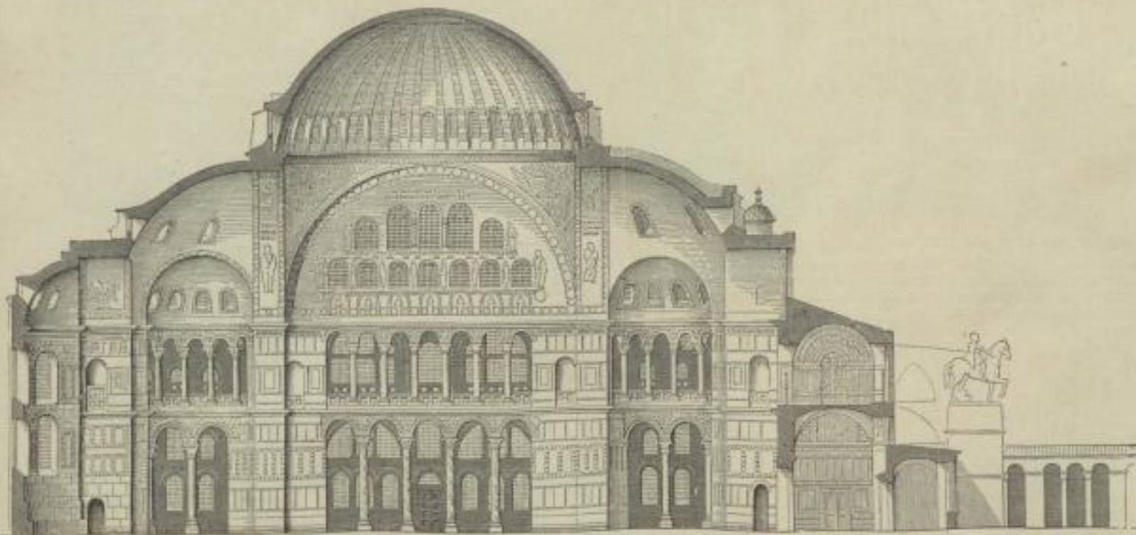
3. Sophienkirche in Constantinopel. Längendurchschnitt. Nach einem Brande 532 neu erbaut unter Justinian von Anthemios von Tralles und Isidoros von Milet.
