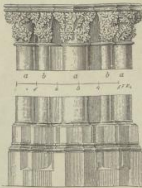
4. Bündelpfeiler mit 4 alten (a) und 4 jungen (b) Diensten (Dreiviertelsäulen). Vom Kölner Dom. Vgl. No. 8.
