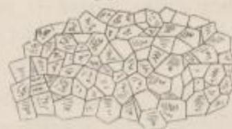
Auf das geebnete Sandbett werden die Steine mit möglichst engen Fugen gesetzt und diese mit Sand ausgefüllt.
