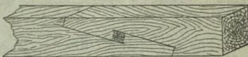
Fig. 595. Das schräge Hakenblatt mit Keil.
