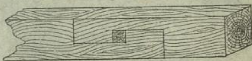
Fig. 592. Das gerade Hakenblatt mit Keil.
