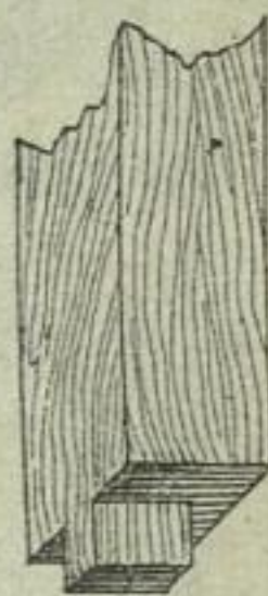
Der zurückgesetzte oder geächselte Zapfen.
