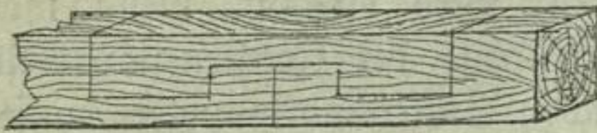
Fig. 587. Stumpfer Stoß mit Holz- klammern.
