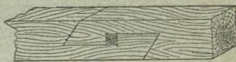
Fig. 593. Das schräge eingeschnittene Blatt mit Keil.
