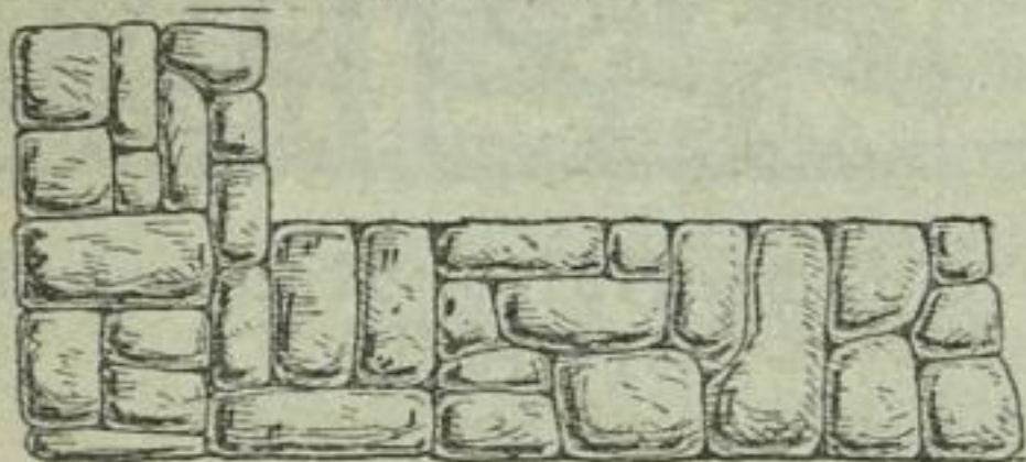
Mauerwerk aus lagerhaften Steinen.
