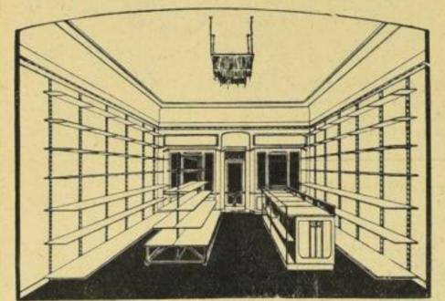
Gesamtbild einer Ladeneinrichtung aus Lochschienen und einhängbaren Trägern bestehend. Außerst billig, stabil und leicht zu transportieren!
