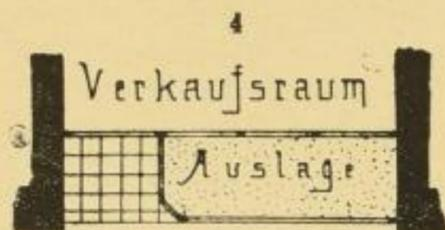
wird man auch hier die scharfen Ecken des Schaufensters abschrägen; noch besser aber ist es, diese Abschragung durch eine runde Scheibe von einem Viertelkreisbogen zu ersetzen. (Vergl. Abbildg. 5.) Dazu gehört allerdings der Einbau einer eigenartigen
