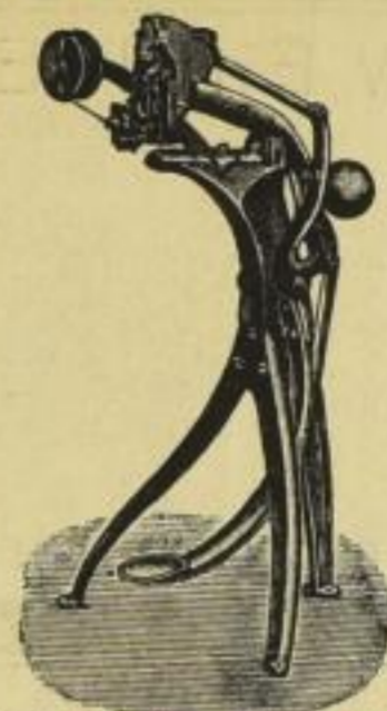
Draht-Heftmaschine Nr. 9 zum Heften von Kartons über die Ecke
