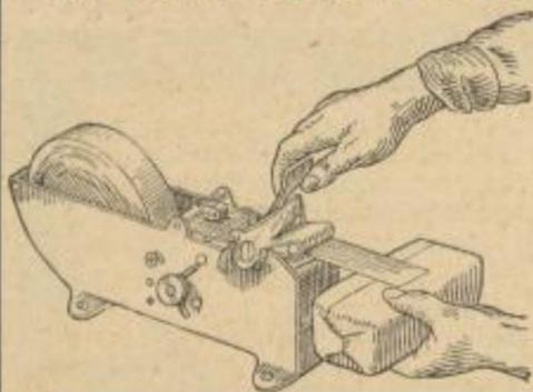
**Ein Hebeldruck** liefert klebefertigen, zugeschnittenen Verschlussstreifen (mit oder ohne Reklamedruck) zu einem Zehntel der Kosten für gummierte Etiketten.
