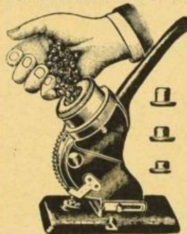
Heftet ohne Lochung mit einfachem Hebeldruck Oesen bis zu 3 mm Kartonstärke. Automatische Zuführung der Oesen. Behälter faßt 2 bis 300 Stück. Hervorragend geeignet zum unlösbar autom. Verschließen von Lohnbeuteln. Unverbindliche Probeflieferung gegen Einsendung von RM. 1.— für Porto.
