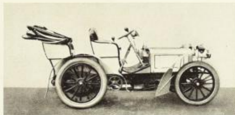
Der erste Kraftwagen in der seiner Eigenart angepassten Form: der „Mercedes“ von 1901, genannt nach der Tochter Jellinek, der Daimler und Maybach zum Bau stärkerer Wagen veranlaßt hatte. 35 PS, 4 Zylinder, 72 km/Stundengeschwindigkeit. Preis rund 20000 Mark.
