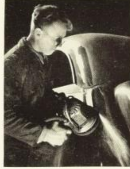
Der letzte Schliff: Glätten der Karosserie mit der Handschleifmaschine.
