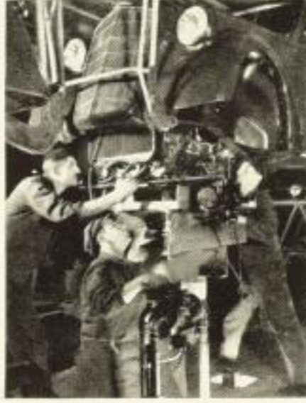
Zusammenbau: Motor und Vorderachse werden mit allen Zubauten durch einen Druckwasserheber eingeschoben.
