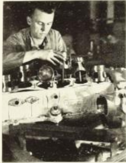
Am „Motorenband“: Einbauen der Kolben in das Motorengehäuse.
