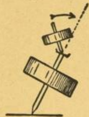
Das Prinzip des Kreiselkompasses
