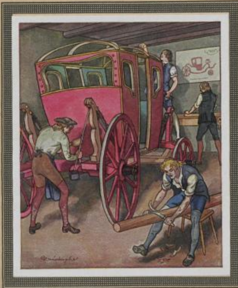
BILD 121: STELLMACHEREI. Der Stellmacher, der in Süddeutschland auch Wagner heißt, fertigte alle aus Holz gearbeiteten Teile des Wagens und oft auch diesen selbst an. Die Wagen hatten damals noch keine Federung, sondern waren in Ledergurten an hölzernen Haltern aufgehängt. Der schlechte Zustand der steinigen Straßen und das holprige Pflaster der Städte machten oft eine Wagenreparatur notwendig.
