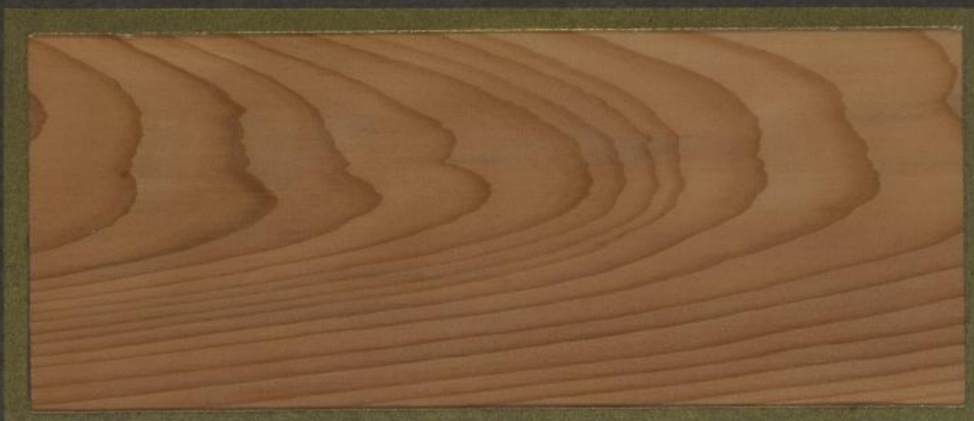
Tangentialer Längsschnitt (Fladerschnitt)
