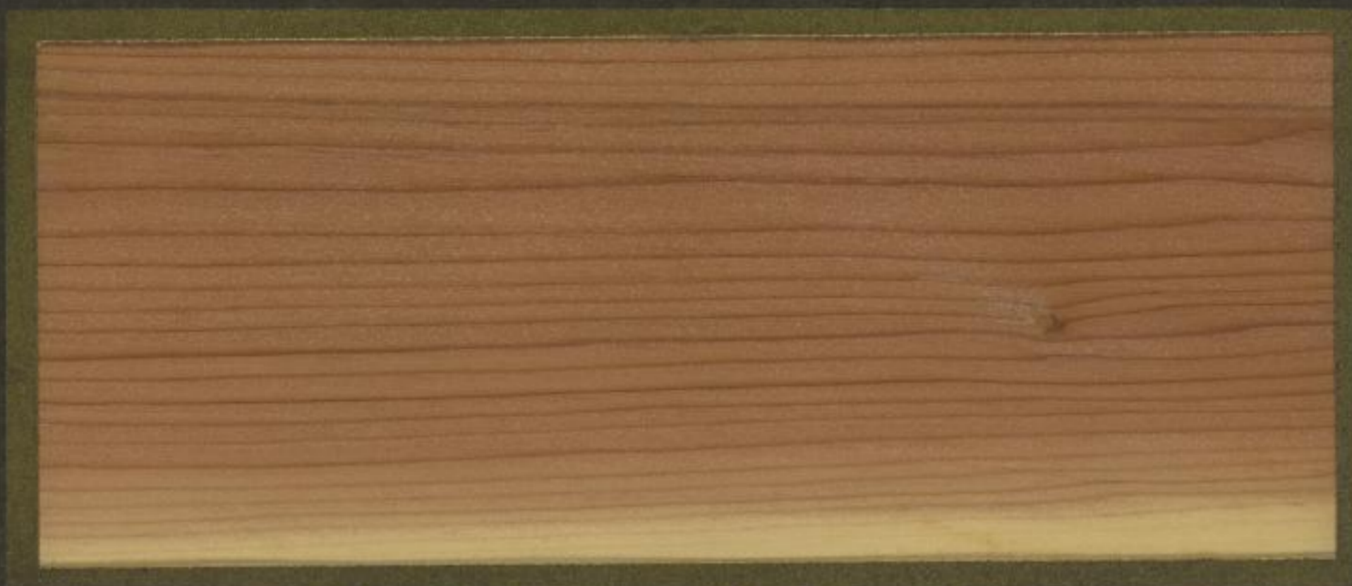
Radialer Längsschnitt (Spiegelschnitt)
