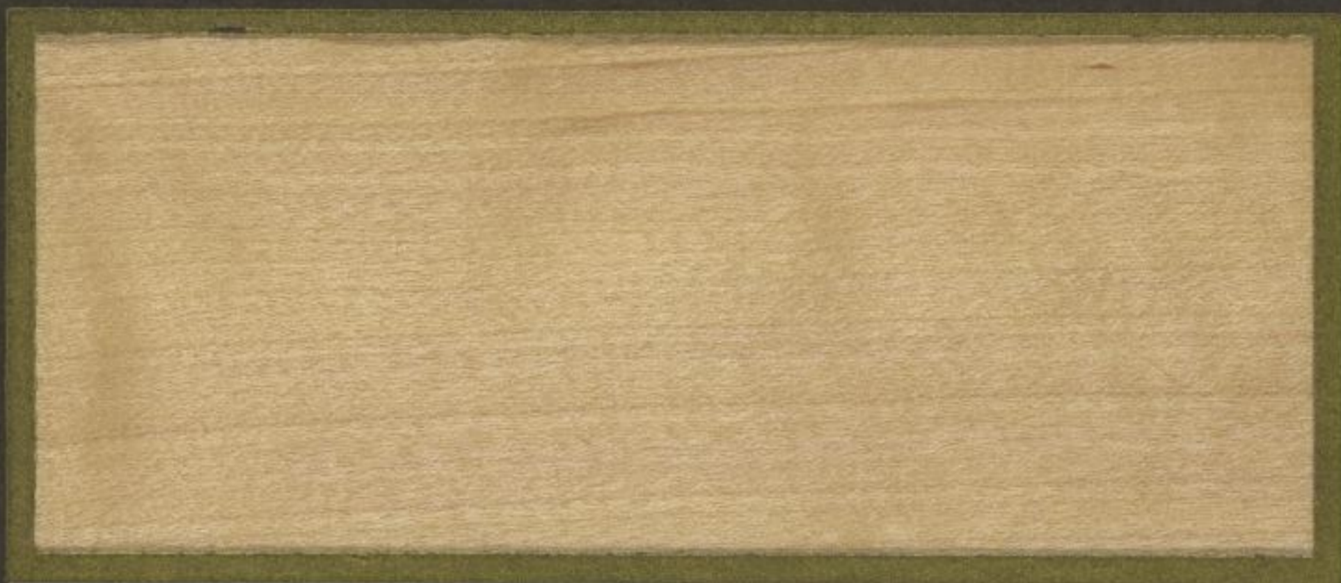
Radialer Längsschnitt (Spiegelschnitt)
