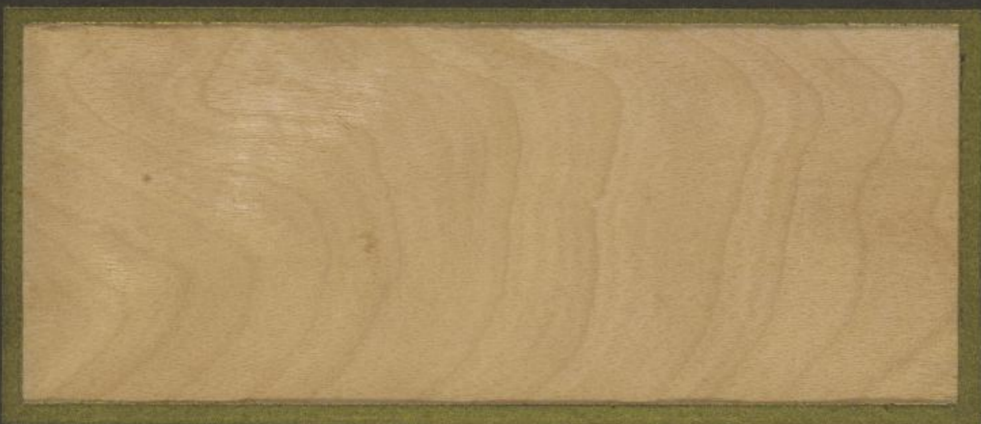
Tangentieller Längsschnitt (Flinderschnitt)
