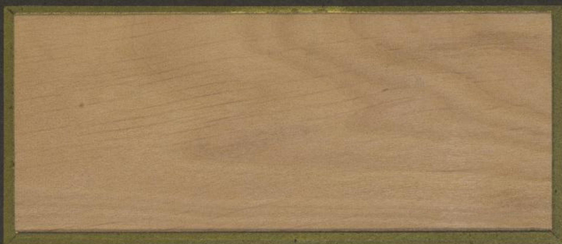
Tangentialer Längsschnitt (Fladerschnitt)
