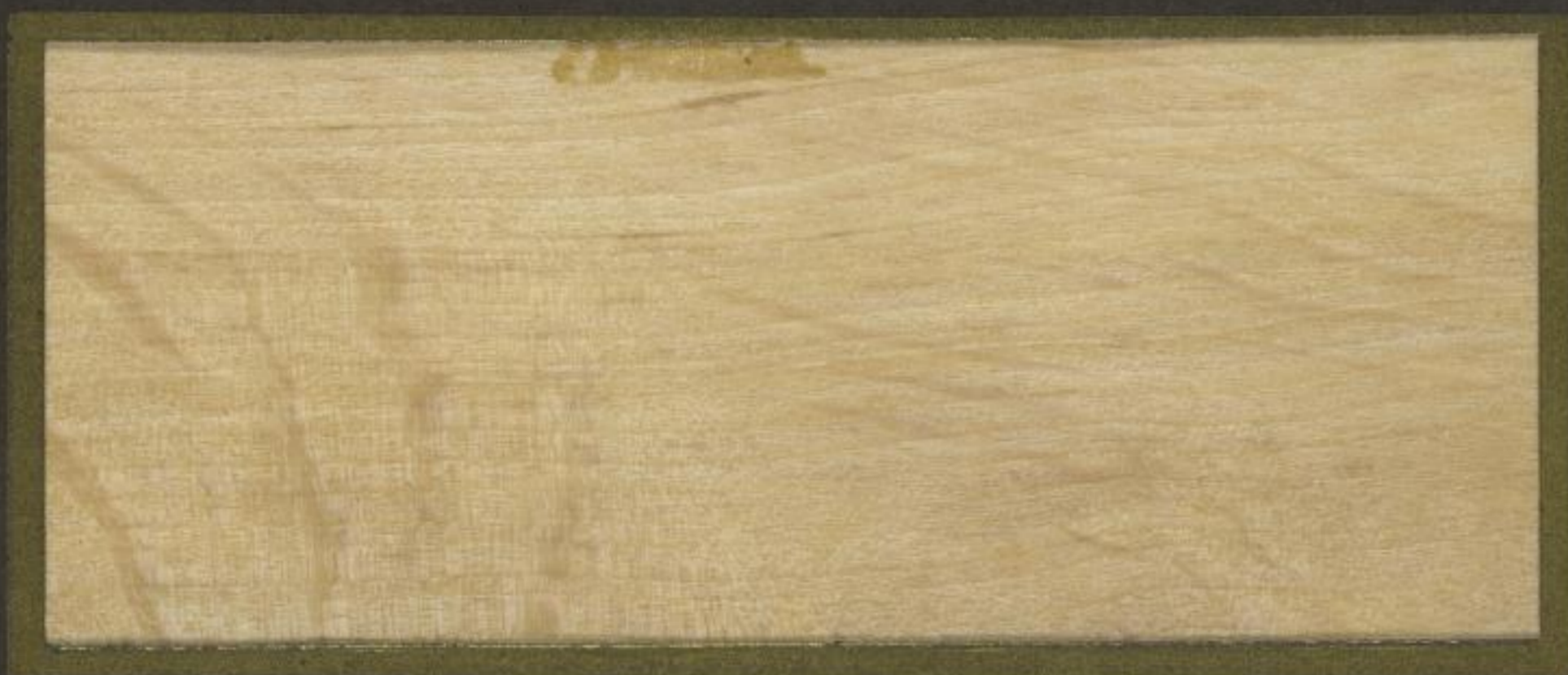
Radialer Längsschnitt (Spiegelschnitt)
