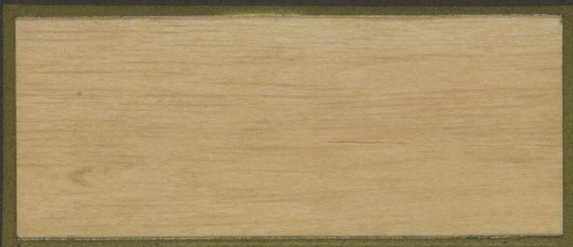
Tangentieller Längsschnitt (Flinderschnitt)
