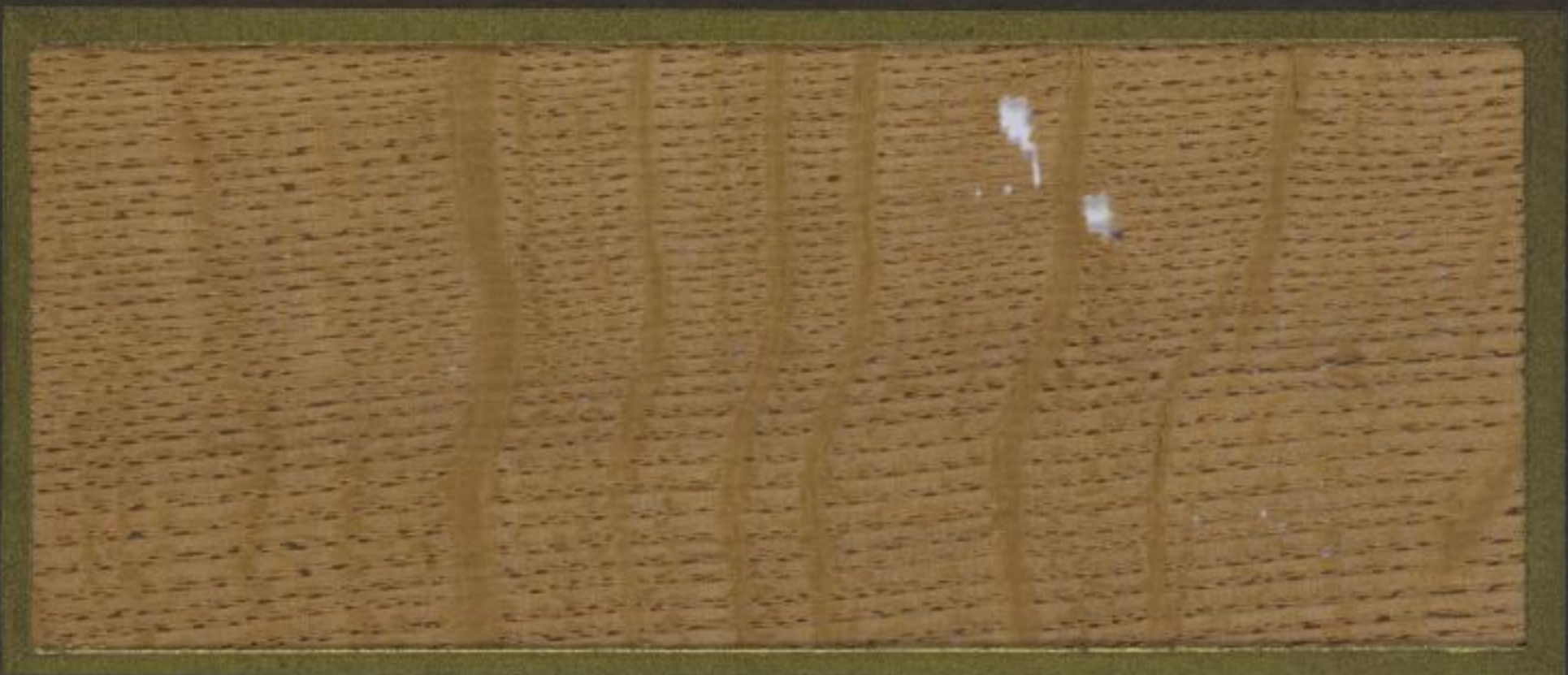
Radialer Längsschnitt (Spiegelschnitt)
