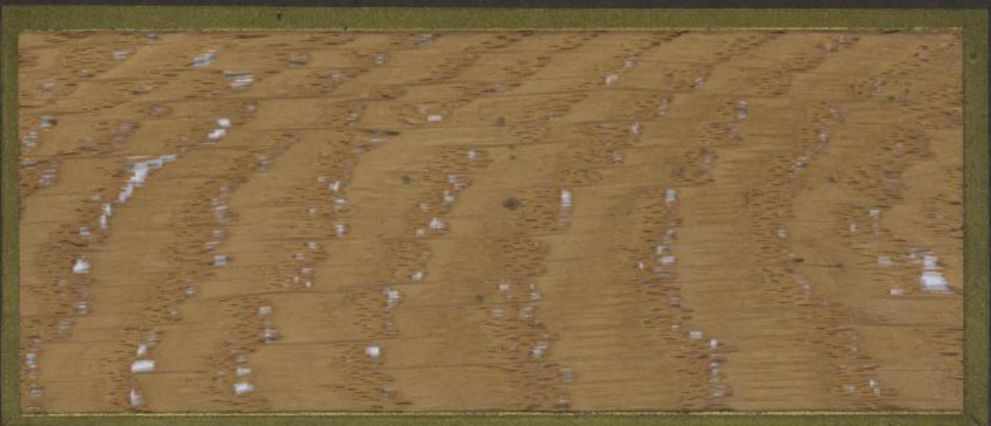
Tangentialer Längsschnitt (Fladerschnitt)
