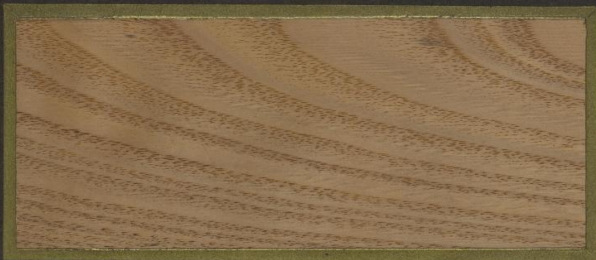
Tangentialer Längsschnitt (Fladerschnitt)
