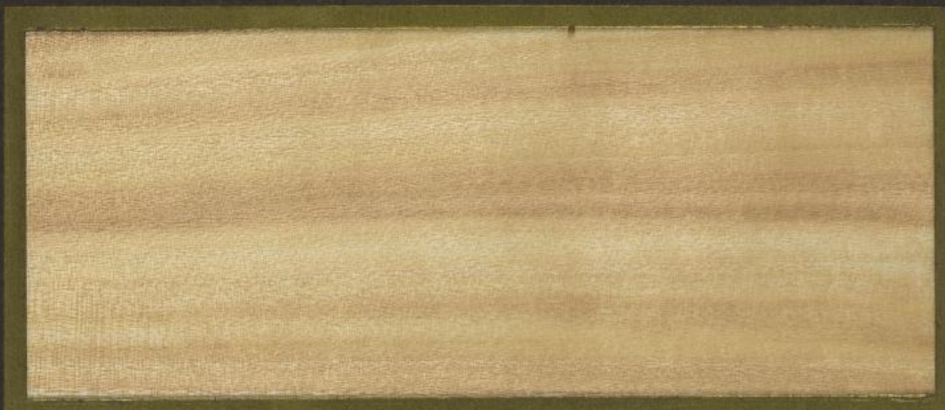
Radialer Längsschnitt (Spiegelschnitt)
