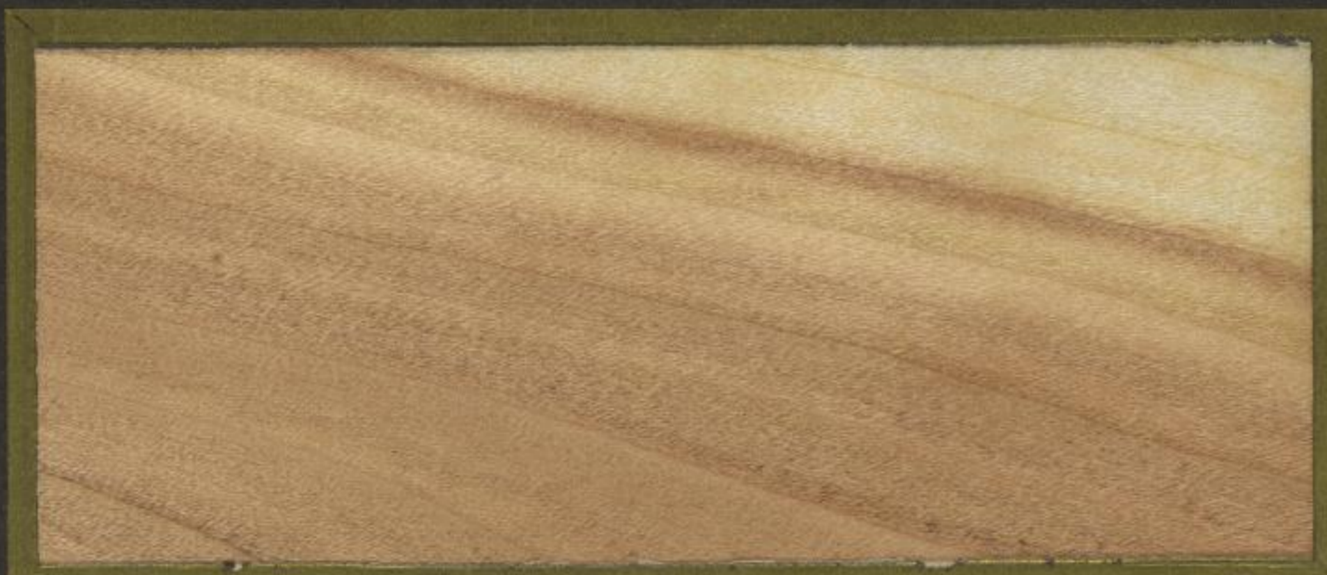
Tangentialer Längsschnitt (Fladerschnitt)
