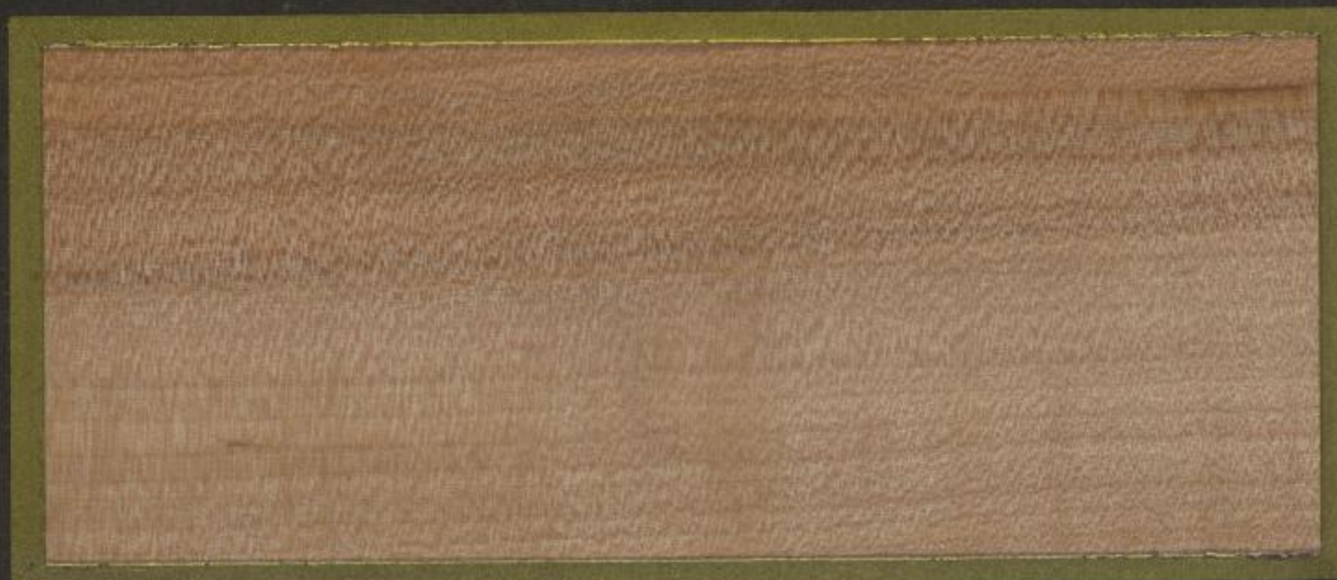
Radialer Längsschnitt (Spiegelschnitt)
