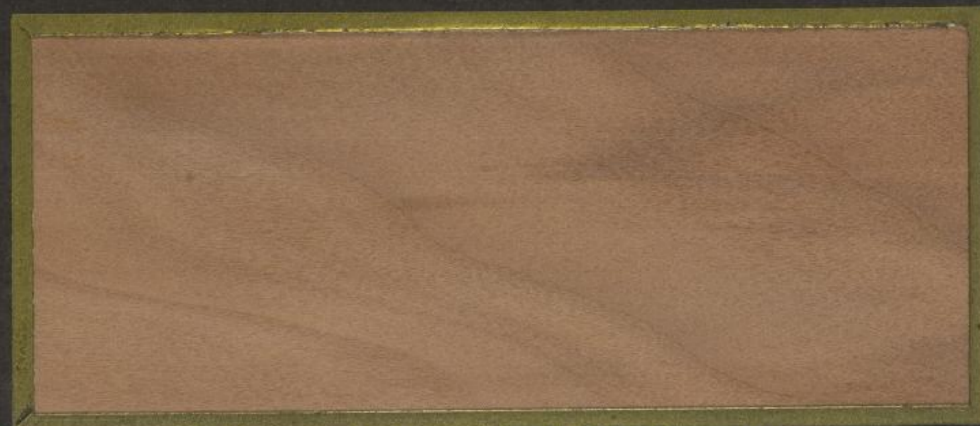
Tangentialer Längsschnitt (Fladerschnitt)
