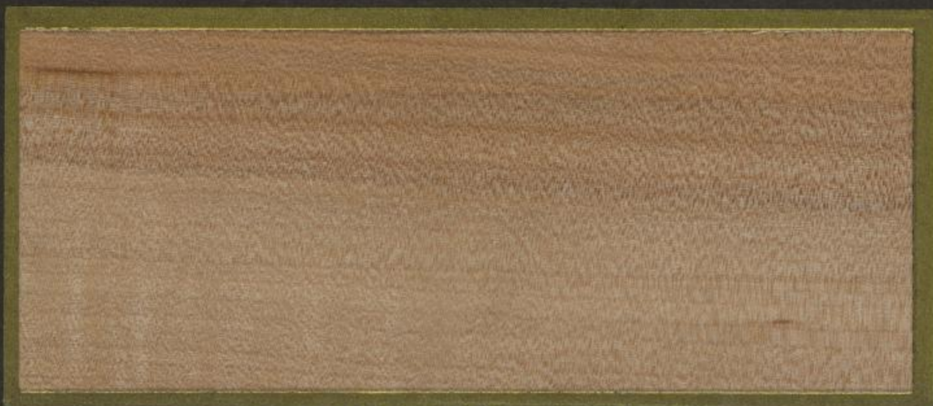
Radialer Längsschnitt (Spiegelschnitt)
