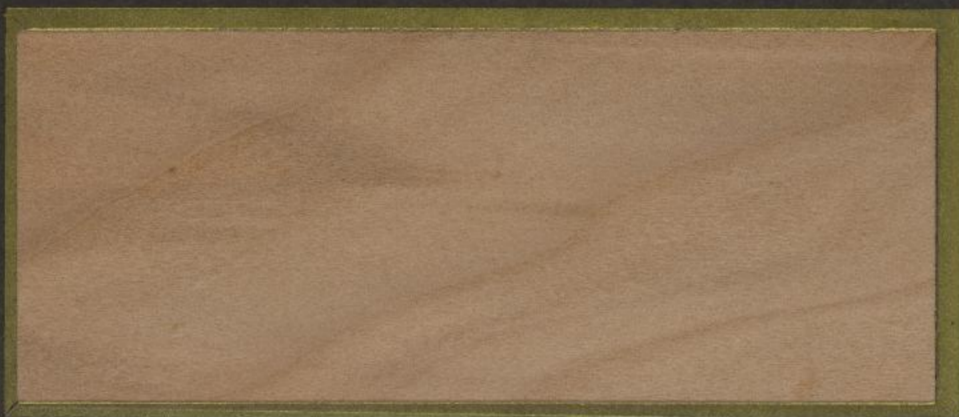
Tangentialer Längsschnitt (Fladerschnitt)
