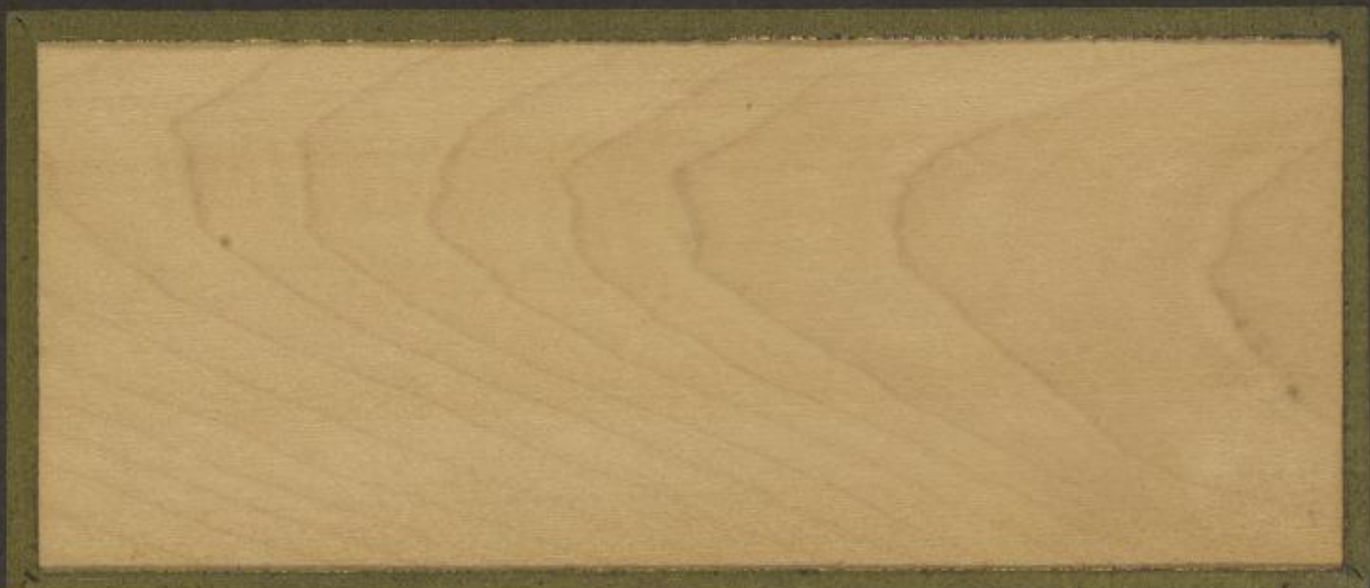
Tangentialer Längsschnitt (Fladerschnitt)
