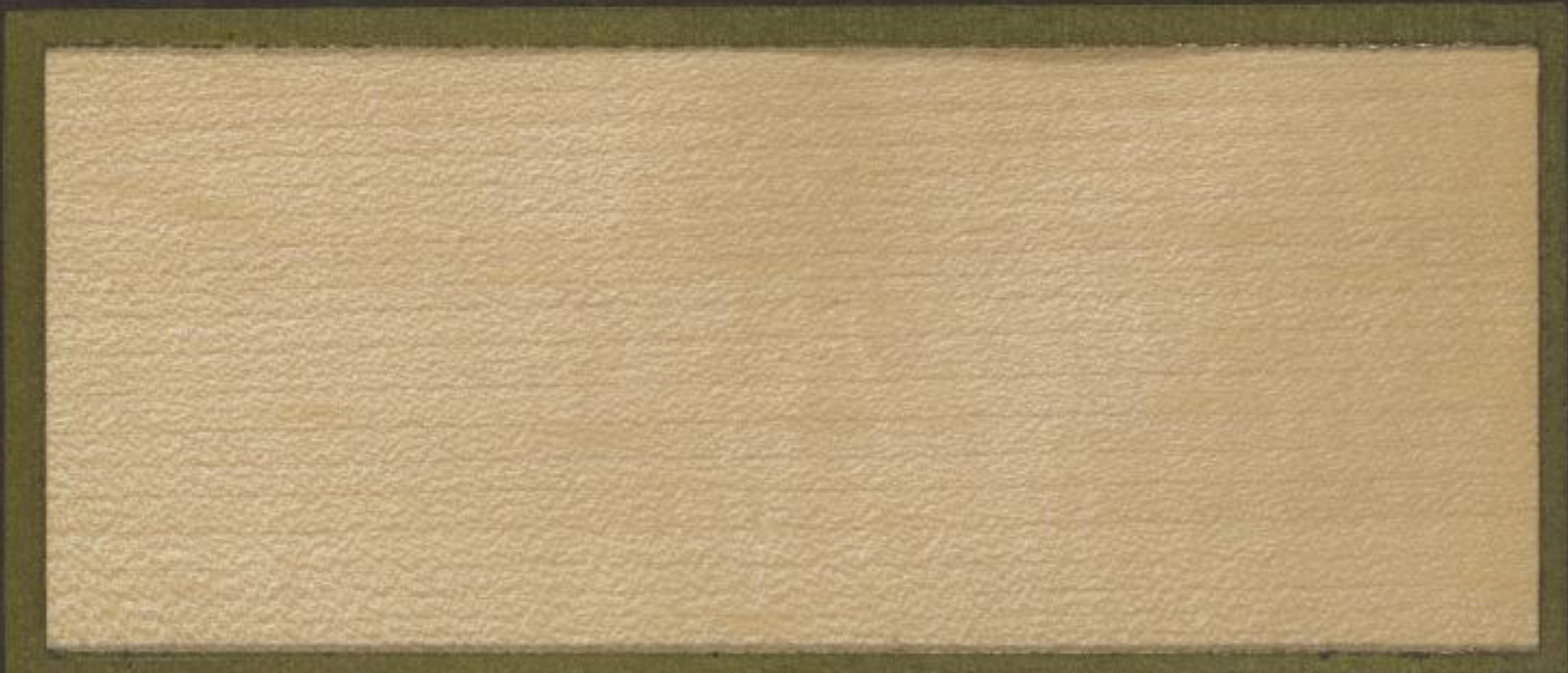
Radialer Längsschnitt (Spiegelschnitt)
