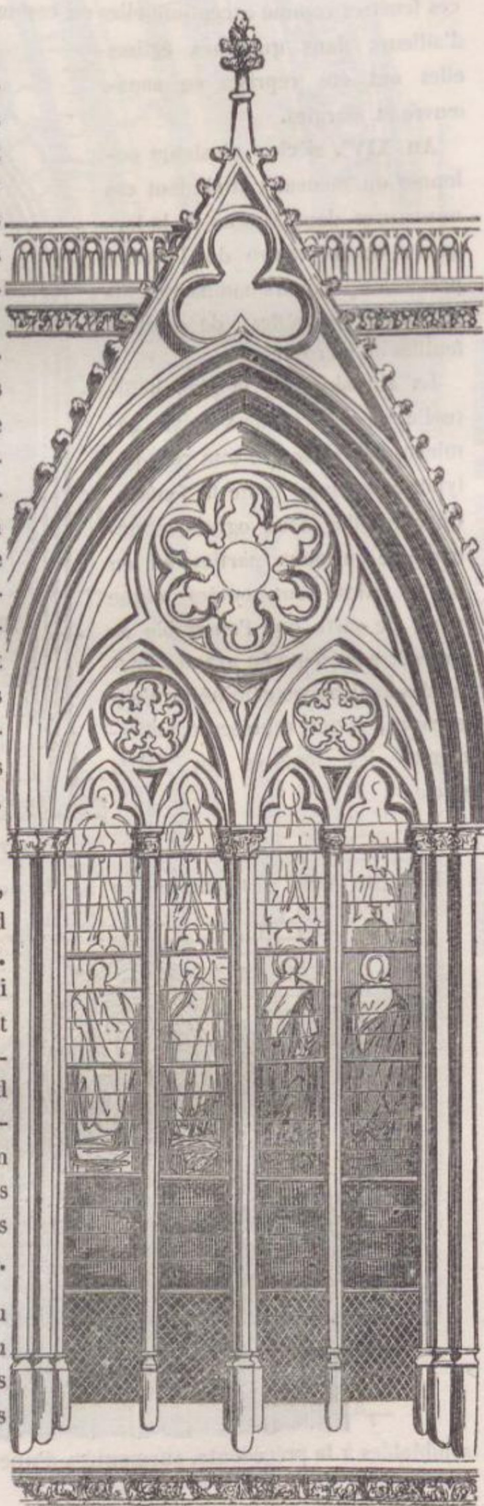
FENÊTRE DE LA NEF DE LA CATHÉDRALE DE METZ, SURMONTÉE D'UN FRONTON GARNI DE CROCHETS, S'ÉLEVANT AU-DESSUS DE LA BALUSTRADE.
